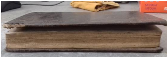
Fig.181 - Dilatação devido à absorção de humidade
