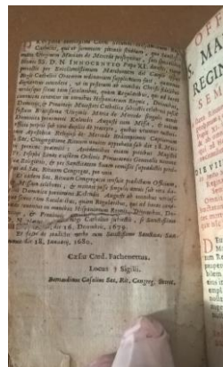
Fig.41 - Linhas de maré, vincos e sujidade
