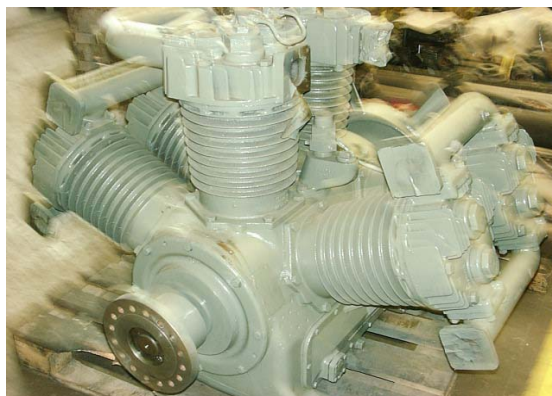
Figura 3.10 – Compressor da série de locomotivas 1960
