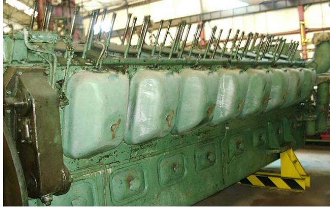
Figura 3.3 – Visualização de um motor diesel de 16 cilindros em V
