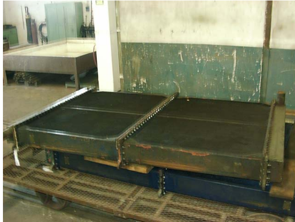
Figura 3.9 – Radiador da série de locomotivas 1960
