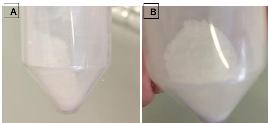
Figura 20 - Fotografias das amostras obtidas pelo método de preparação Nano spray drying. NPs com pentamidina (A) e sem pentamidina (B).
