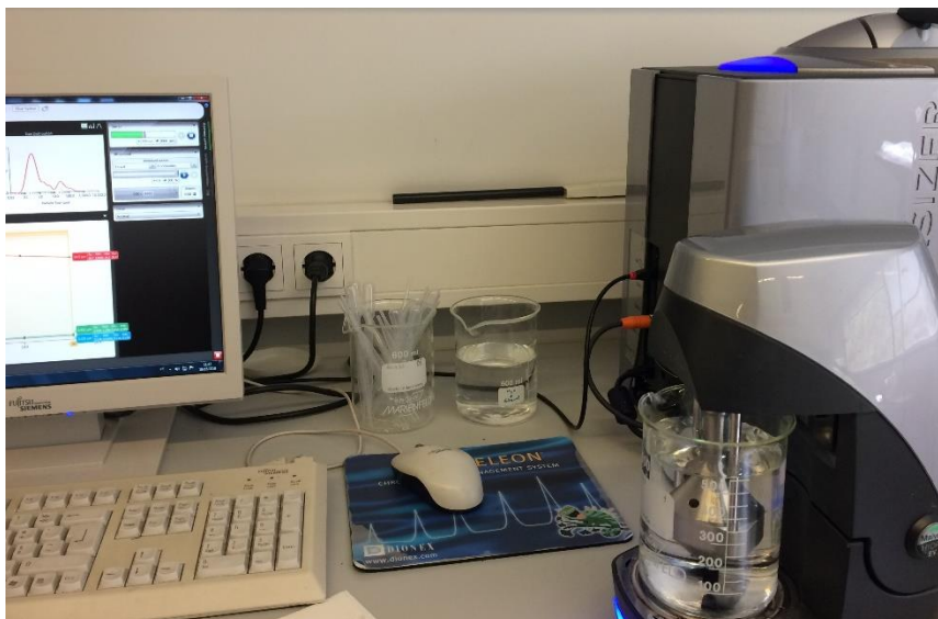
Figura 24 - Fotografia do aparelho LD com ligação informática ao software correspondente.
