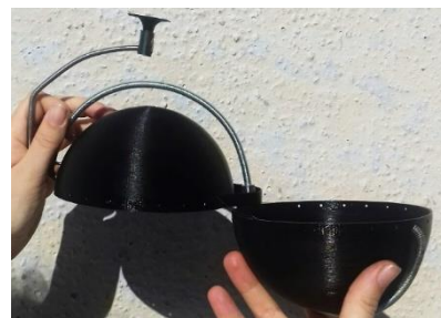
122. Apresentação do protótipo em aço e ABS (aberto)
