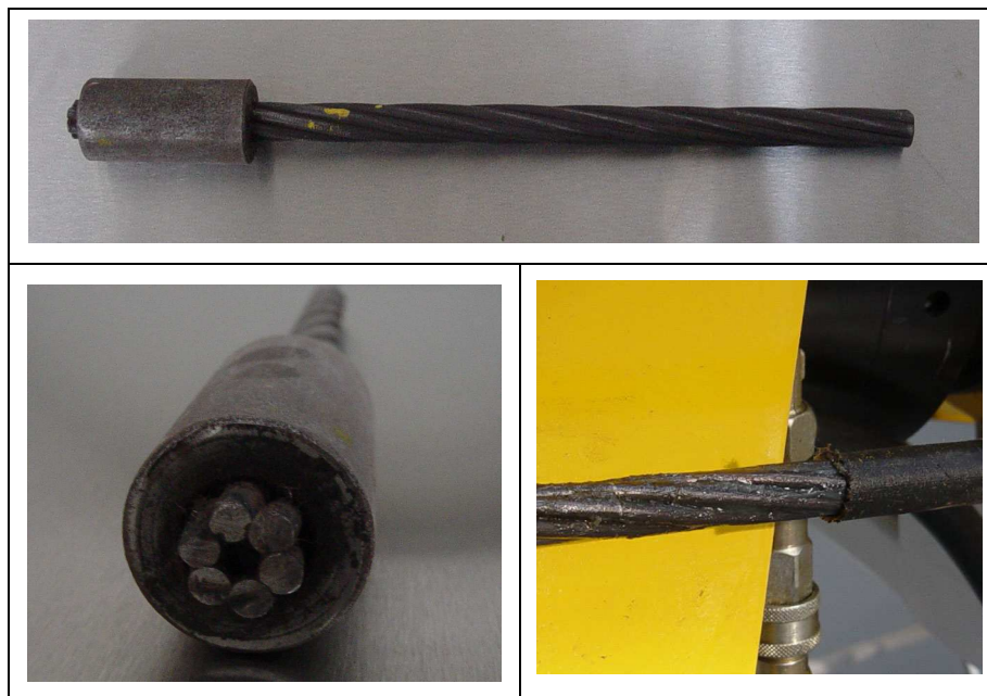
Figura IV.37 – Cabo auto-embainhado e extrusão definitiva
