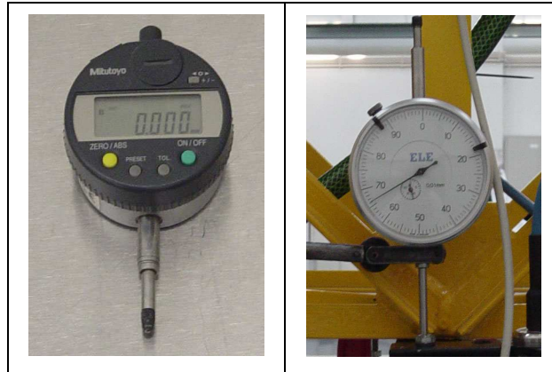
Figura IV.28 – Comparadores mecânicos de engrenagem, de leitura digital e analógica
