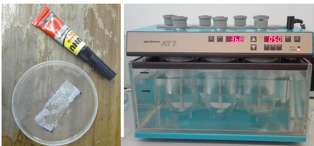
Figura 11. A) Vidro de relógio com a película bucal; B) Aparelho de dissolução utilizado durante o ensaio.
