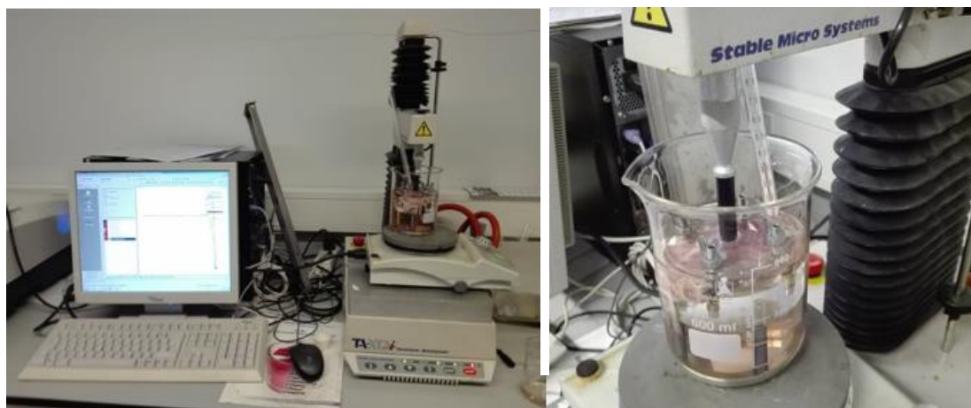
Figura 9. Texturómetro equipado com dispositivo de medição de mucoadesão.
