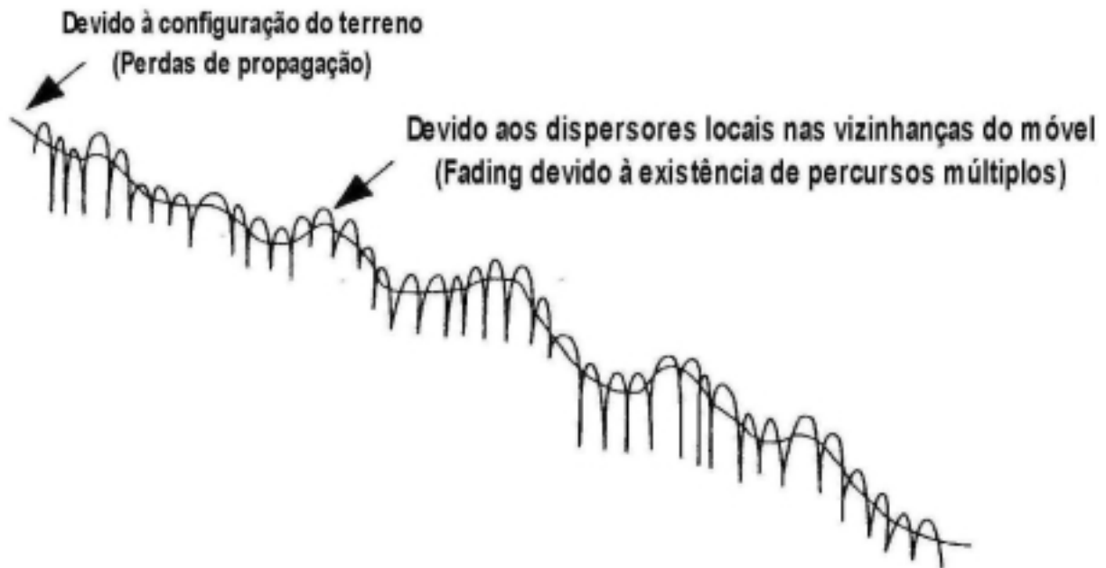
Figura 3.3: Sinal s(t) , dado pelo produto dos sinais m(t) e r(t) . [Fujimoto 94].
