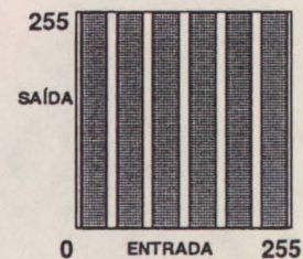
fig. 7.10 - "LUT" utilizada para obter as isoclínicas da fig. 7.12.
