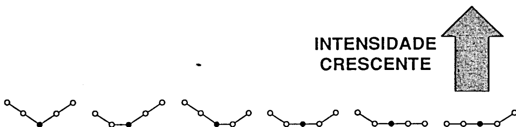
fig. 5.16 - Padrões básicos usados para a detecção de mínimos locais.
