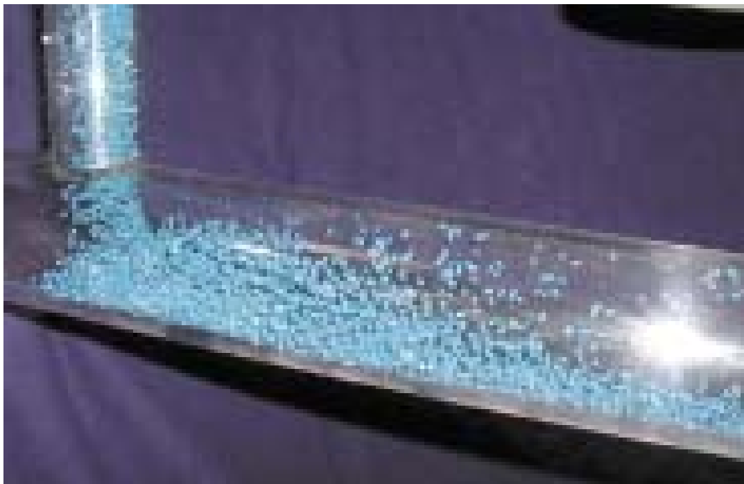
Figura 1.1 – Escoamento bifásico gás-sólido (Transporte Pneumático).
