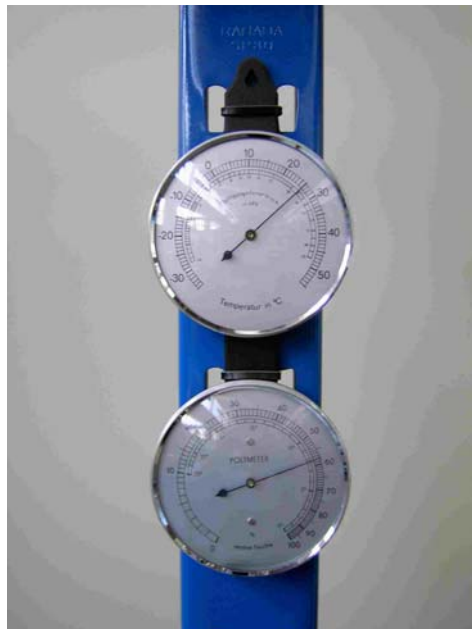
Figura 2.11 – Conjunto termómetro/higrómetro usado para medição da temperatura ambiente.
