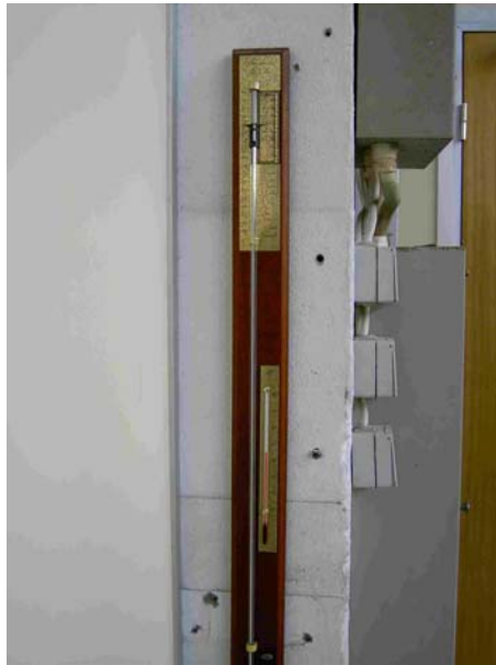
Figura 2.10 – Barómetro usado para medição da Pressão atmosférica.
