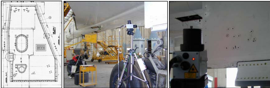
Figura 7.43 – Controlo de uma porta de trem de aterragem através da Shearography .
