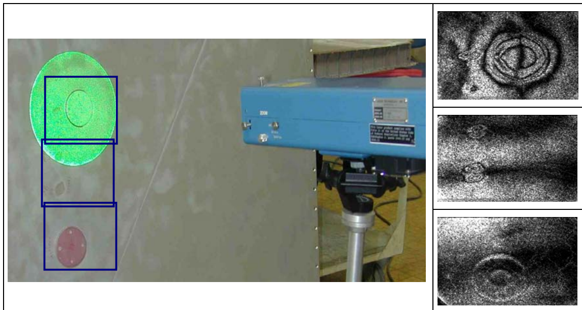
Figura 7.28 – Resultados da inspecção por Shearography pós reparação num componente de aeronáutica
