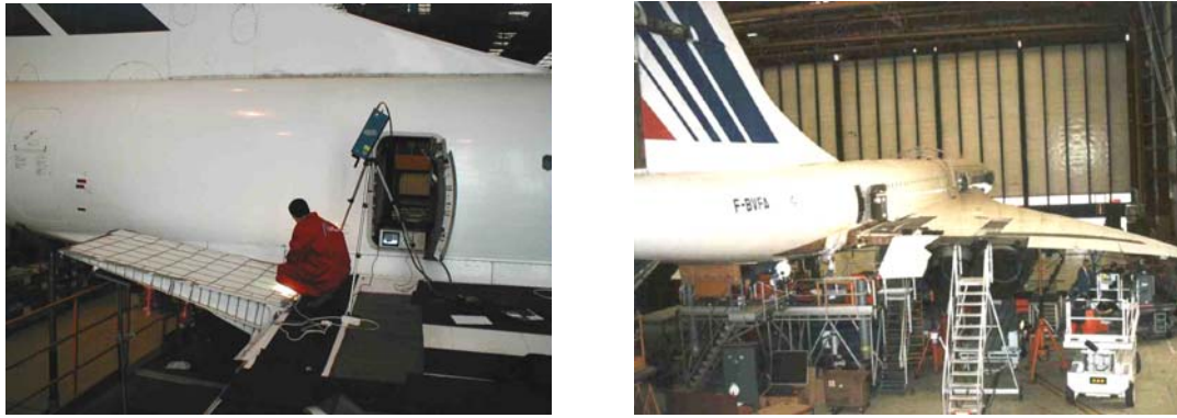
Figura 7.40 – Inspecção shearografica em condições reais dos Elevons.
