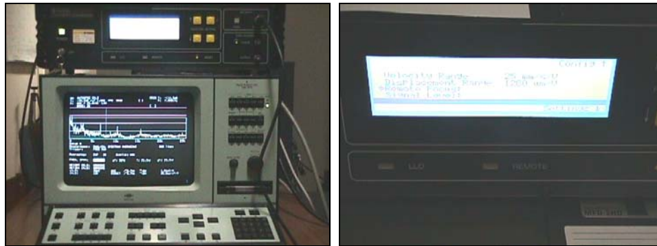
Figura 6.31 – Sistemas utilizados na determinação da resposta em frequência da pá de turbina.
