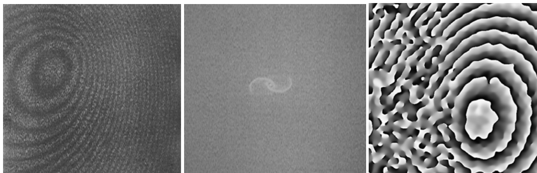
Figura 4.14 – Padrão secundário com portadora de frequência insuficiente. Padrão de franjas, espectro de Fourier e mapa de fase com erros.
