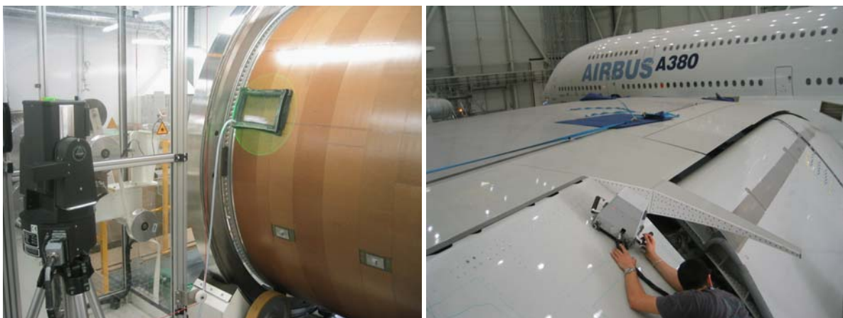
Figura 1.10 – a) Utilização da Shearography no controlo de colagem de um propulsor de missile balístico. b) Utilização da Shearography no controlo de danos de impacto dos ailerons do Airbus A380.
