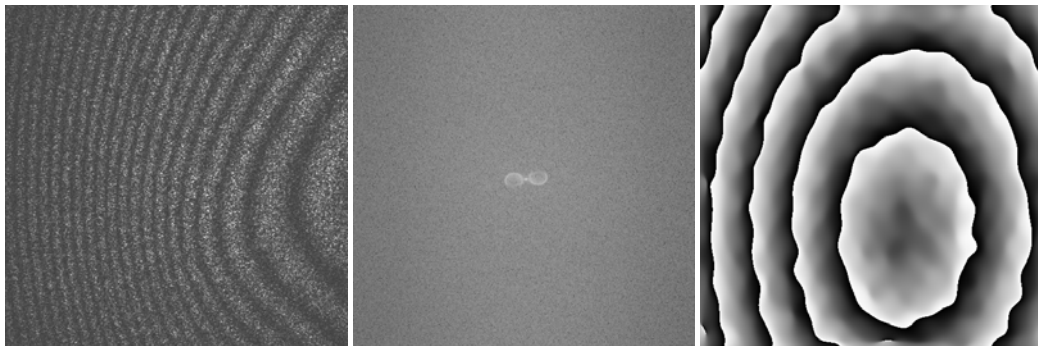
Figura 4.13 – Determinação de um mapa de fase a partir da introdução de uma portadora num padrão de franjas secundárias. Padrão de franjas, espectro de Fourier e mapa de fase.
