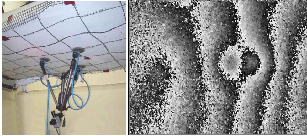
Figura 7.42 – Sistema de shearography Q800 em utilização na parte inferior de um elevon e imagem de fase.
