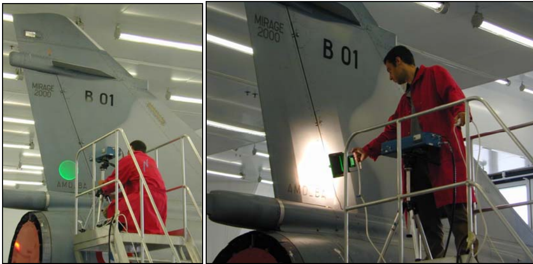
Figura 7.31 – Configuração de inspecção utilizada para controlar o leme de direcção da aeronave Mirage 2000.
