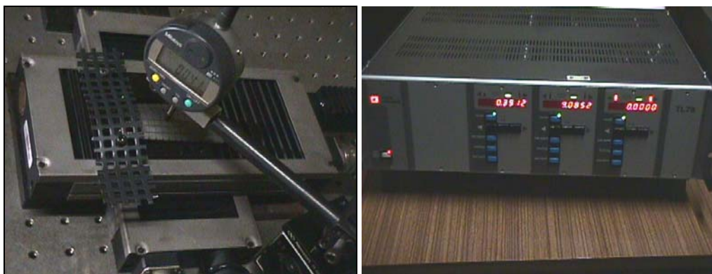
Figura A3 – Montagem experimental e controlo das mesas de translação para o levantamento de forma O resultado da obtenção das coordenadas espaciais do sólido numa malha 3D representa-se na figura A4.
