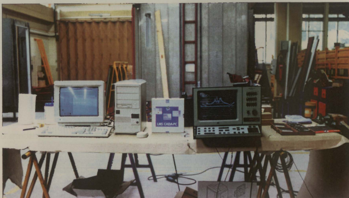
Figura 5.5 - Analisador e “software” de identificação modal CADA-PC da LMS.
