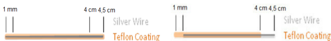
Figura 9: Esquema da estrutura dos elétrodos de pasta de carbono durante a sua preparação.
