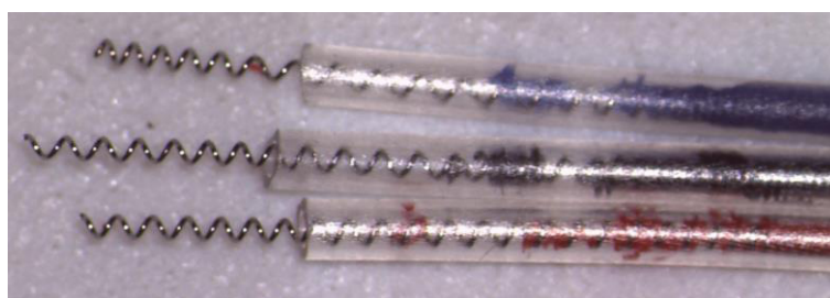
Figura 10: Fios de ligação à unidade de comunicação, com as cores identificativas e as espirais onde os eléctodos serão introduzidos. As espirais foram esticadas e cortadas sensivelmente com o mesmo comprimento, encontrando-se prontas para a introdução dos eléctodos previamente preparados.
