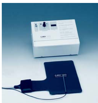
Figura 2: Controlador de temperatura CMA/150. O equipamento monitoriza e regula a temperatura do animal anestesiado. A unidade de controlo indica a temperatura medida pela sonda rectal e regula a potência para a placa que aquece o animal. Fonte: adaptado da referência (CMA/Microdialysis, 2003).
