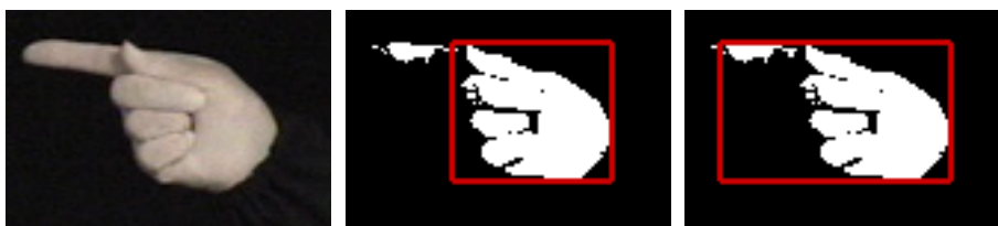
Figura 4.7 – Melhoria dada pela flexibilização do algoritmo de localização da zona de projecção horizontal mais larga
