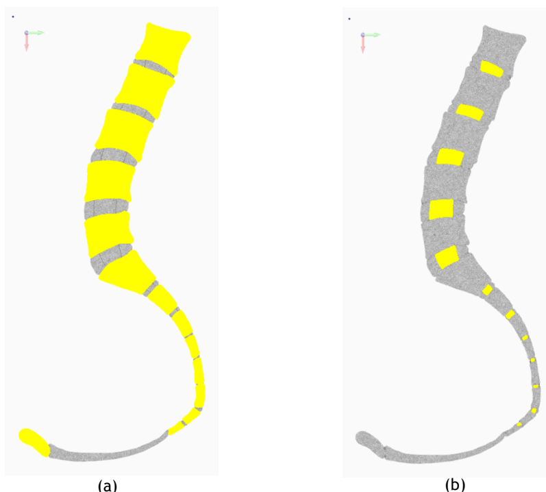
Figura 7.7 - Resultado da modelação do modelo bidimensional no Femap. A primeira imagem (a) representa o modelo com a malha gerada e o tecido ósseo agrupado onde é possível ver as vértebras lombares, sacro, cóccix e osso púbico. Na segunda imagem (b) temos os núcleos dos discos intervertebrais marcados e diferenciados do anel fibroso.
