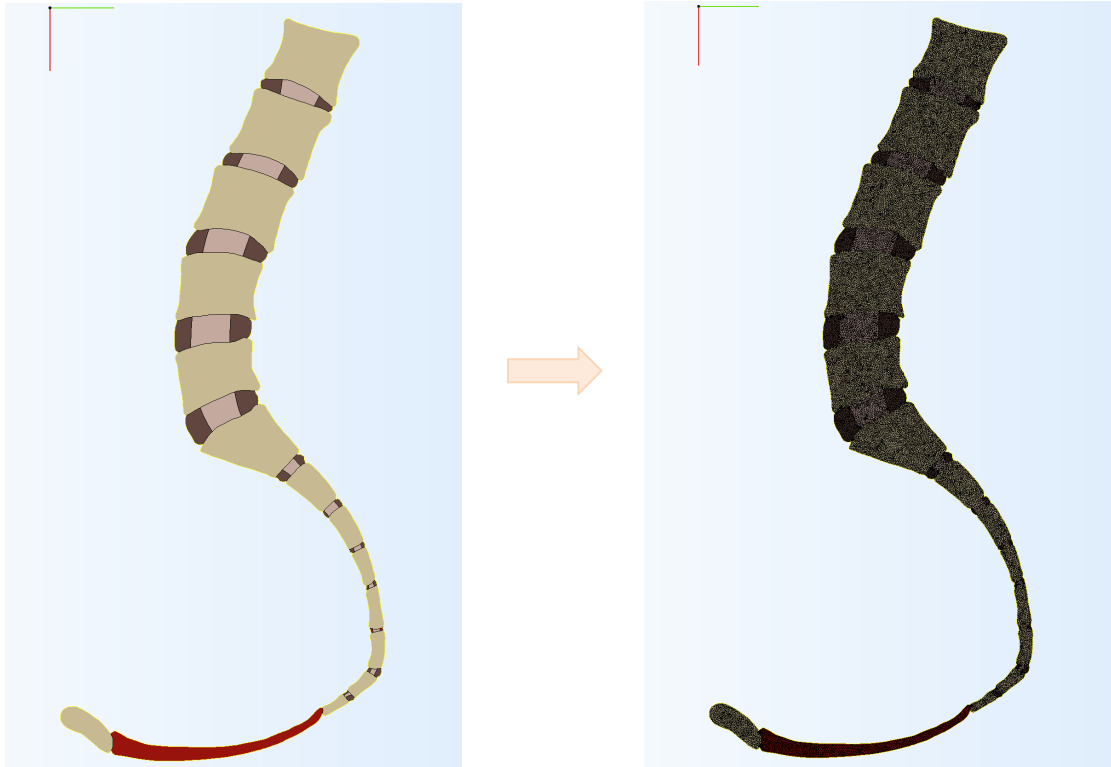
Figura 7.5 - Representação do modelo 2D no 3-Matic após a segmentação da imagem médica. À esquerda temos o modelo 2D com as estruturas agrupadas em partes segundo as suas propriedades mecânicas e tecidos a que pertencem, com os contornos suavizados, à direita temos o modelo praticamente pronto para exportação para o Femas, com as malhas triangulares acrescentadas.
