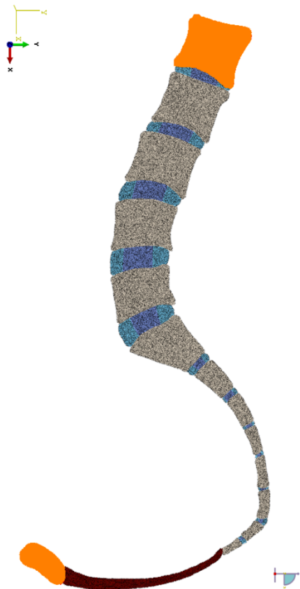
Figura 8.2 - Modelo bidimensional com as condições de fronteira aplicadas à primeira vértebra lombar (L1) e ao osso púbico.
