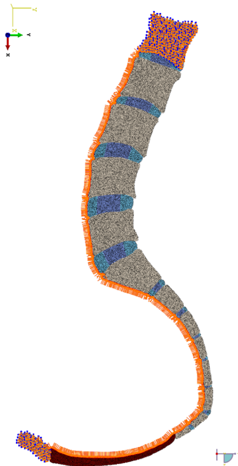
Figura 8.4 - Modelo bidimensional com a pressão intra-abdominal aplicada ao longo de toda a estrutura lombar, sacral e pavimento pélvico à exceção da primeira vértebra lombar (L1) e osso púbico.
