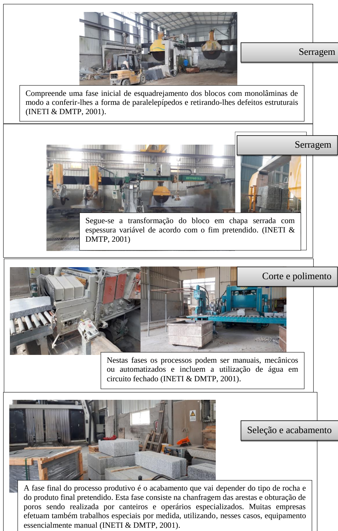
Figura 14 – Processo produtivo da rocha ornamental – transformação da pedra
