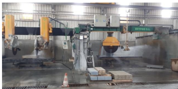
Máquina de corte de pedra de pequena dimensão
