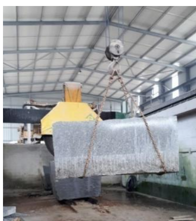
Colocação da pedra na máquina de corte
