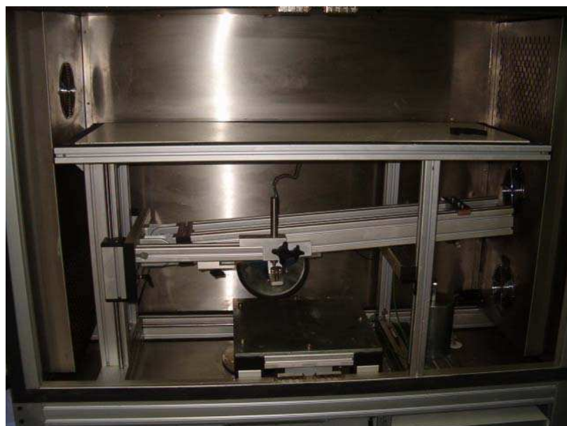
Figura 4.19 – Equipamento Wheel Tracking
