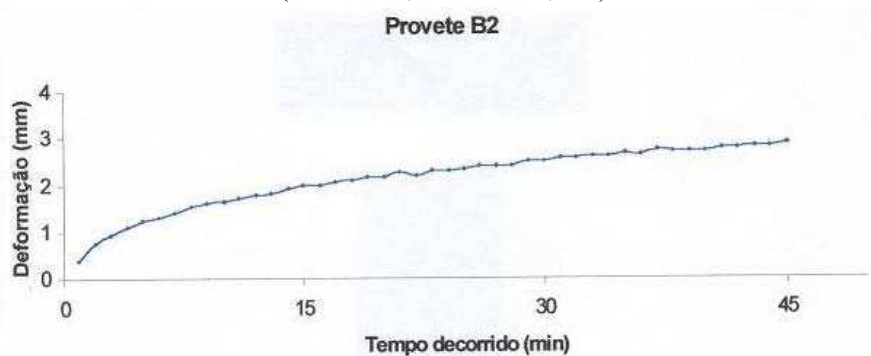
Figura 4.97 – Evolução da deformação com o tempo de ensaio. Provete B2. (TR=30%; Pbtot=5,1%)
