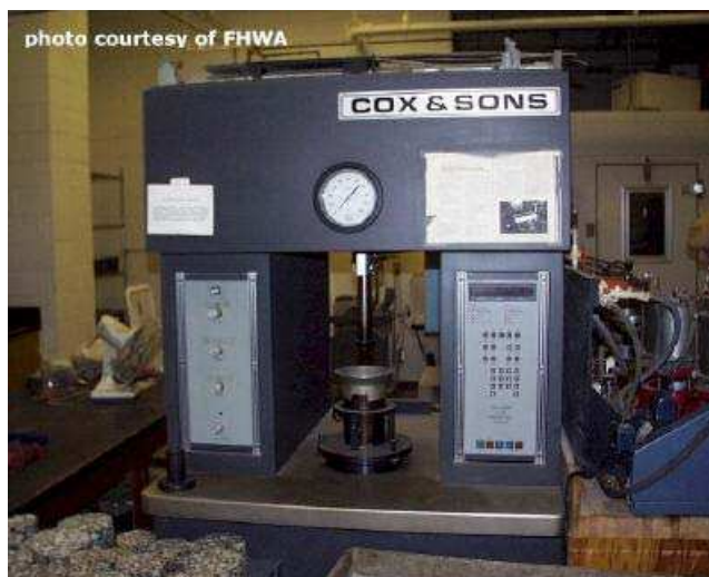
Figura 3.25 - Compactador Kneading (NAPA, 2002)
