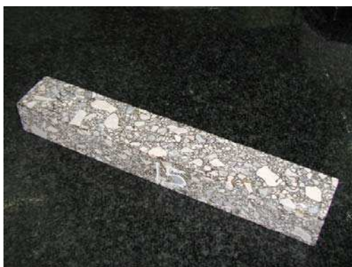
Figura 4.111 - Provete para ensaio à fadiga
