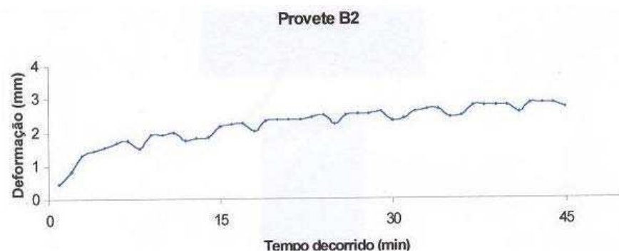
Figura 4.79 – Evolução da deformação com o tempo de ensaio. Provete B2. (TR=15%; Pbtot=4,3%)
