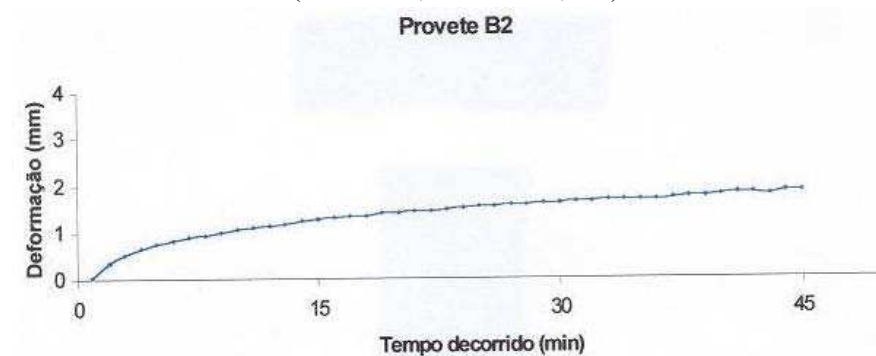
Figura 4.91 – Evolução da deformação com o tempo de ensaio. Provete B2. (TR=30%; Pbtot=4,3%).
