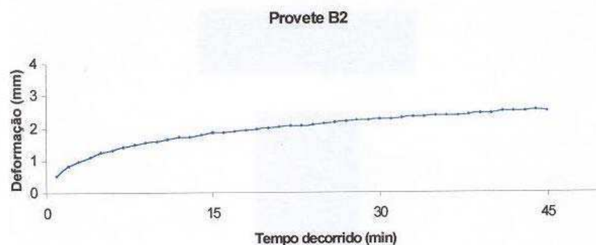
Figura 4.85 – Evolução da deformação com o tempo de ensaio. Provete B2. (TR=15%; Pbtot=5,1%).
