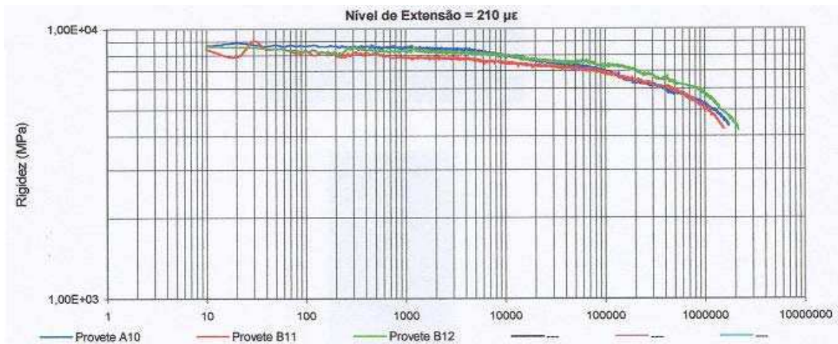
Figura 4.65 – Evolução do módulo de rigidez com o número de ciclos para um nível de extensão de 210 \mu\epsilon (TR=30%; Pbtot=5,1%)
