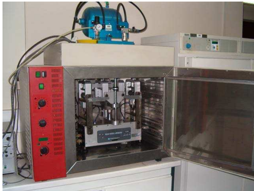
Figura 4.18 – Equipamento utilizado para os ensaios de módulo de rigidez e de resistência à fadiga
