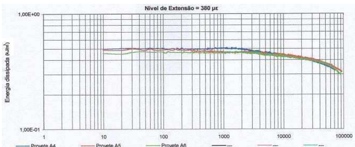
Figura 4.67 – Evolução da energia dissipada com o número de ciclos para um nível de extensão de 380 \mu\epsilon (TR=30%; Pbtot=5,1%)
