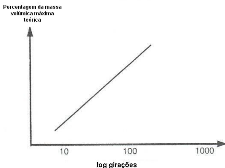
Figura 3.33 – Características da mistura devido à compactação do compactador de corte giratório SUPERPAVE (AI, 1997b)
