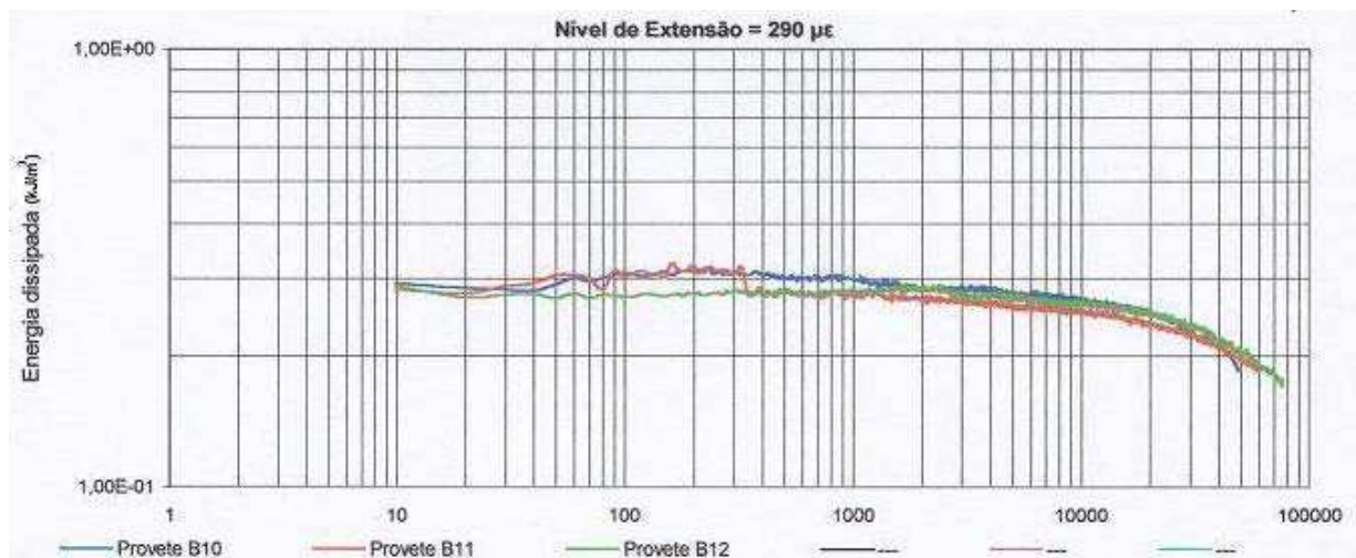
Figura 4.59 – Evolução da energia dissipada com o número de ciclos para um nível de extensão de 290 \mu\epsilon (TR=30%; Pbtot=4,3%)
