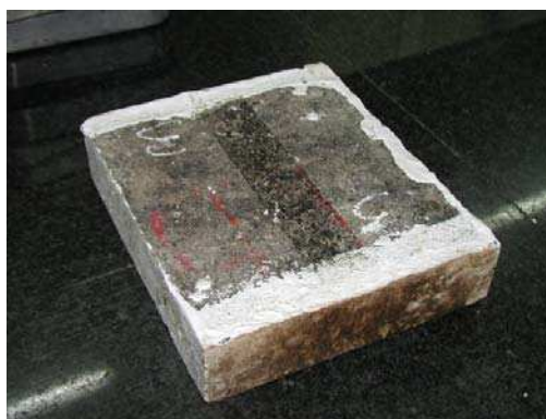
Figura 4.112 - Provete para ensaio às deformações permanentes
