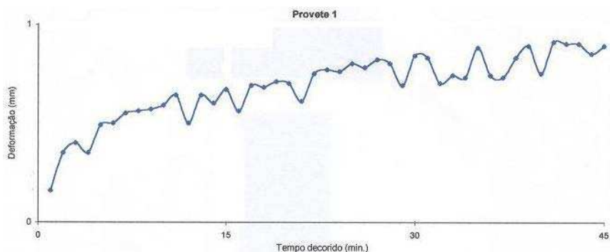
Figura 4.122 – Evolução da deformação com o tempo de ensaio. Provete P1. (Mistura aplicada em obra)
