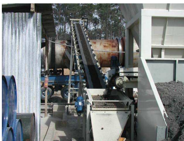
Figura 4.106 – Introdução no anel central das misturas betuminosas fresadas
