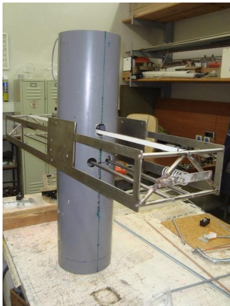
Figura 4.45 - Corpo central fixo com elemento anelar estrutural e tirantes montados.
