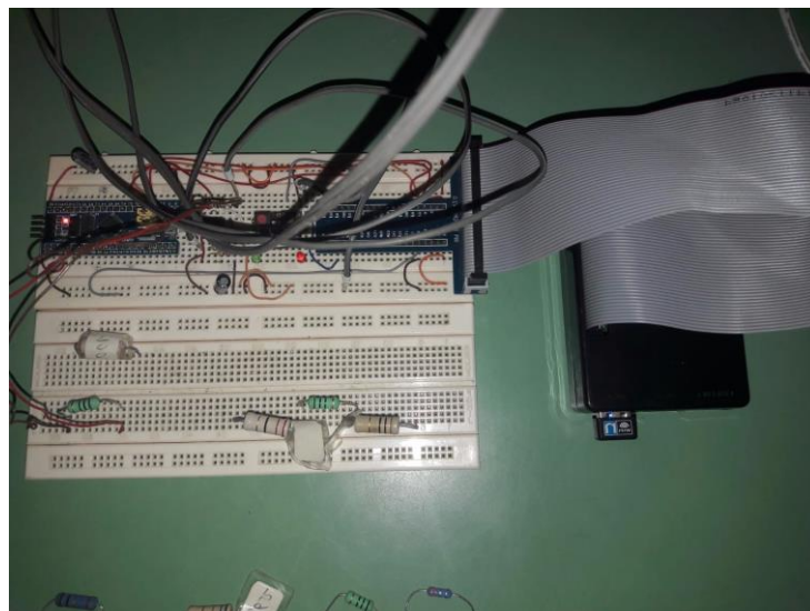
Figura 4.9 - Board do sistema de monitorização do PTO.
