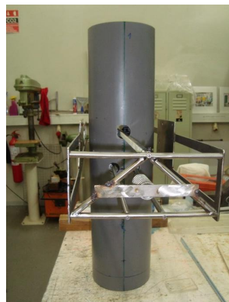
Figura 4.45 - Corpo central fixo com elemento anelar estrutural e tirantes montados.
