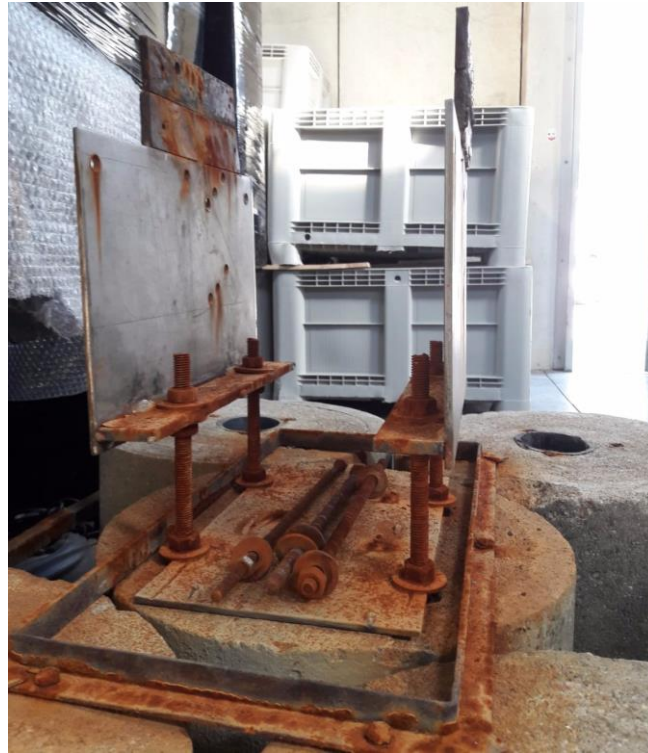
Figura 4.36 - Sistema de compensação da altura na base do modelo.
