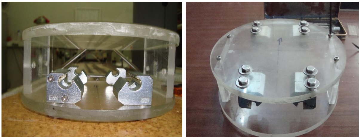
Figura 4.40 - Parte inferior do sistema de guiamento dos tirantes.
