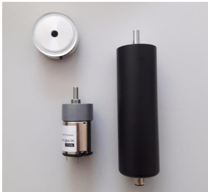
Figura 4.6 - Motor com a caixa redutora de 10x (à esquerda) e motor de caixa de redutora de 24x (à direita).
