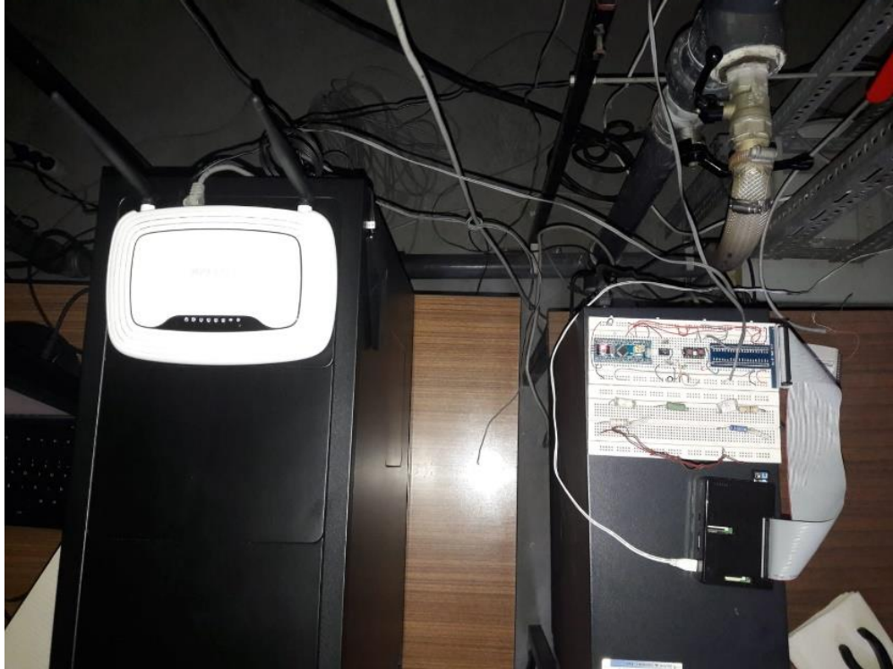
Figura 4.7 – Board , microcomputador e router de ligação do Sistema de Monitorização do PTO.
