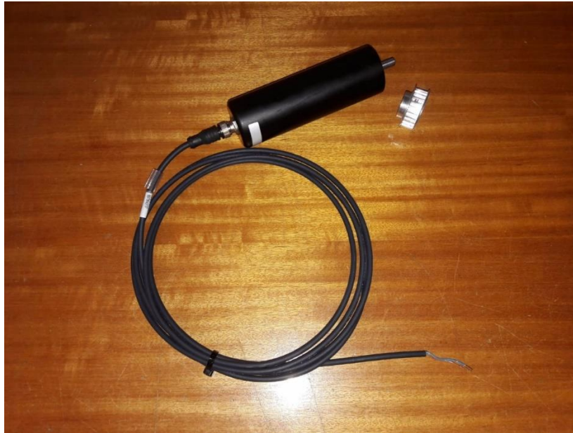
Figura 4.5 - MOT-DC-42-M-A-D e o respetivo cabo de ligação.
