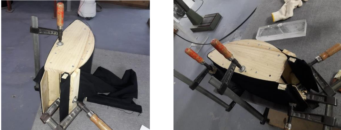
Figura 4.19 - Molde de Madeira usado para a moldagem dos módulos laterais móveis.
