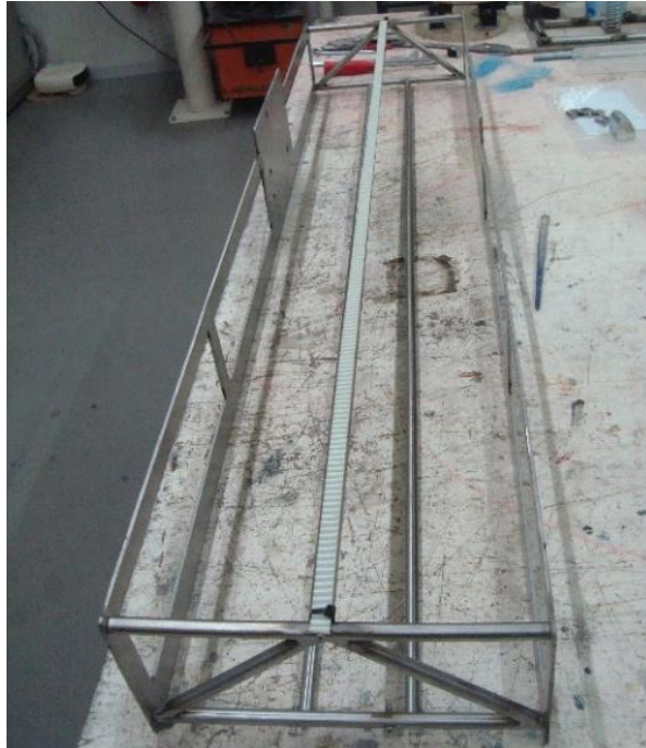
Figura 4.33 - Correia sincronizadora instalada no superior tirante quadrado.
