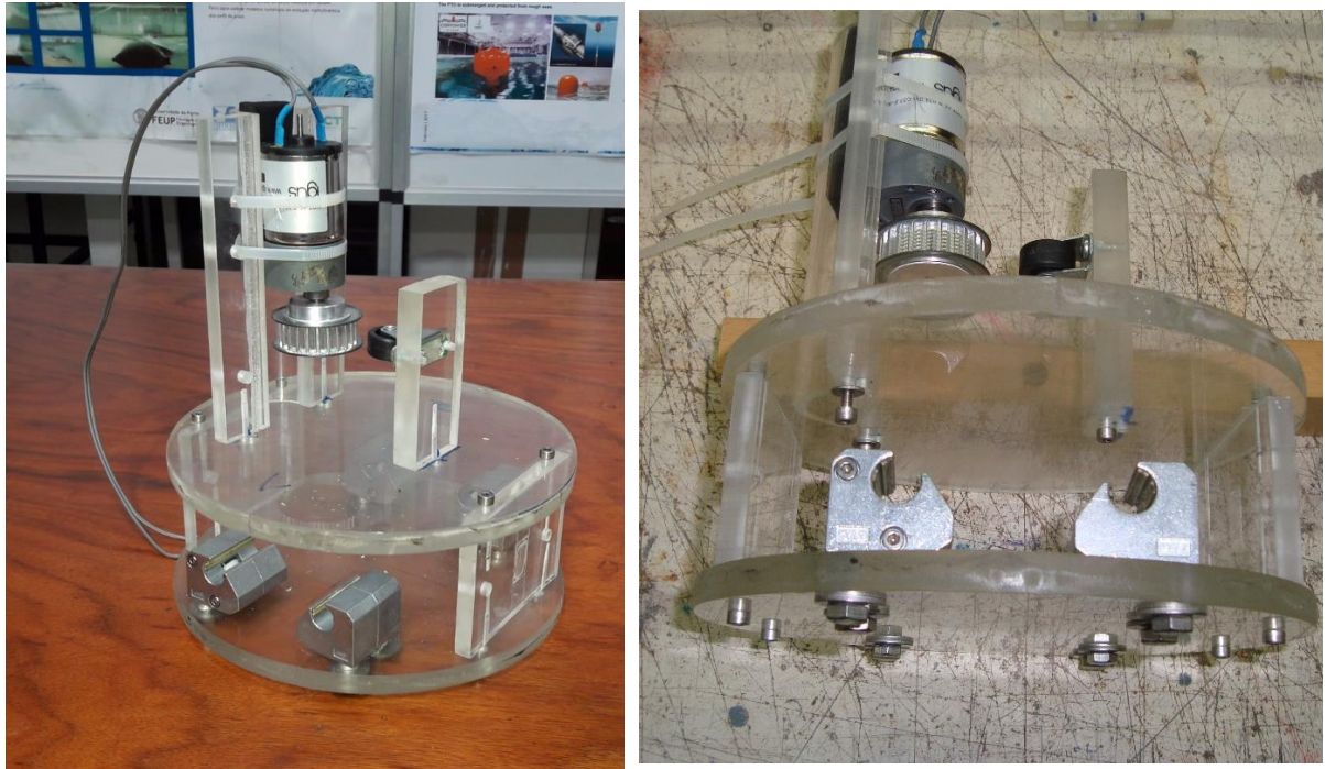
Figura 4.41 - Sistema de guiamento dos tirantes inicial.
