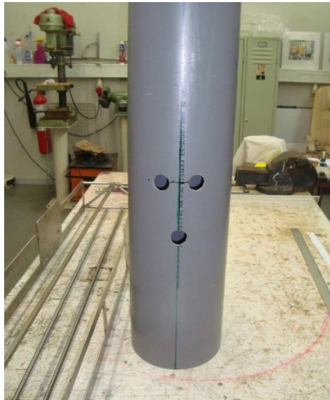
Figura 4.38 - Tubo PVC com a furação para os tirantes.
