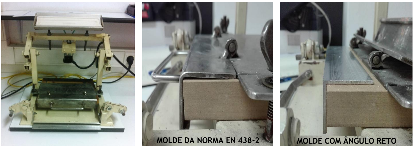
Figura 15 - Equipamento utilizado para os ensaios de formabilidade, bem como os dois moldes testados nos ensaios.
