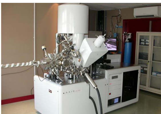
Fig. 8 - X-ray photoelectron microscopy equipment at Centro de Materiais da Universidade do Porto.
