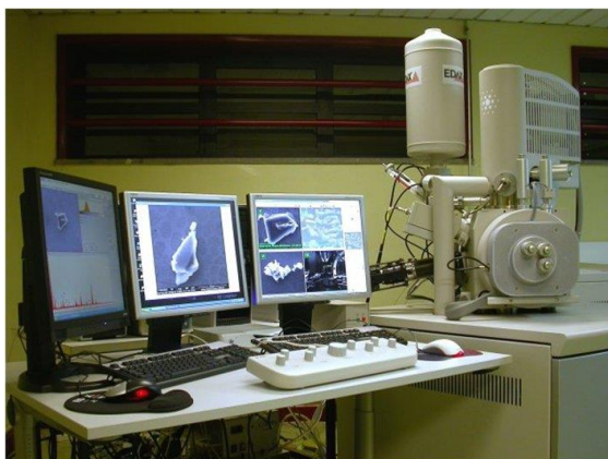
Fig. 7 - Scanning electron microscopy equipment at Centro de Materiais da Universidade do Porto.
