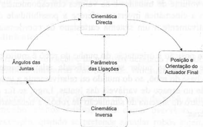
Figura 3.5: Relação entre a cinemática directa e a cinemática inversa [Laloni, 1995]
