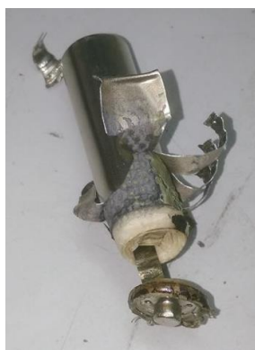
Figura 3.3 - Célula eletroquímica recarregável aquando da abertura.
