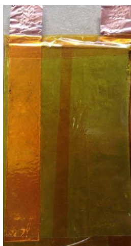
Figura 4.17 - Bateria montada com aço inoxidável como coletor de corrente
