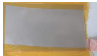
Figura 3.16 - Base da bateria montada com coletor de corrente
