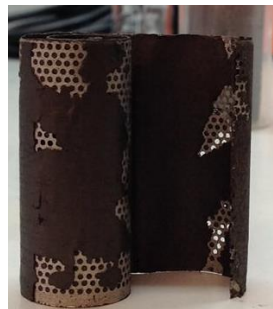
Figura 3.13 - Eléctrodo negativo da célula eletroquímica
