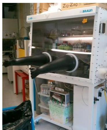
Figura 3.2 - Caixa de luvas utilizada nos ensaios experimentais realizados [11]
