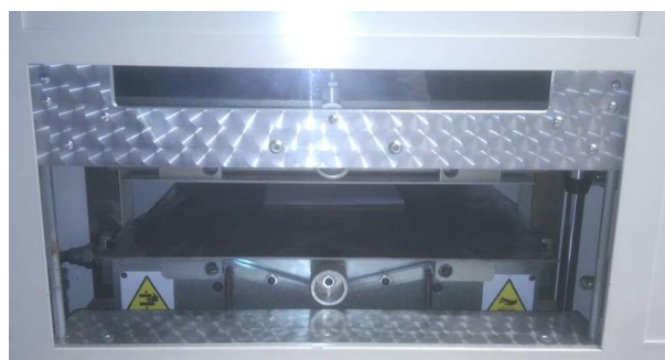
Figura 3.25 - Laminado dentro da prensa de pratos quente
