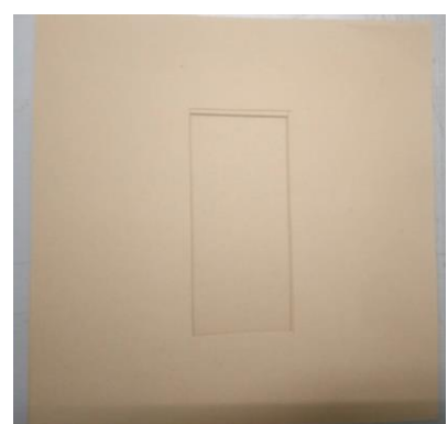
Figura 3.22 - Base do laminado com o reservatório para a bateria
