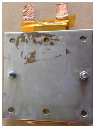
Figura 4.13 - Suporte para a bateria montada experimentalmente
