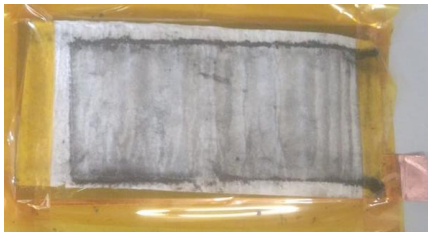
Figura 3.17 - Colocação do eletrodo negativo e separador na base
