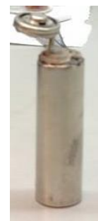
Figura 3.11 - Bateria após a sua abertura
