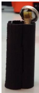
Figura 3.12 - Eléctrodo positivo da célula eletroquímica
