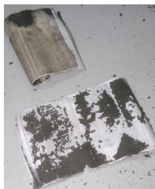
Figura 3.4- Célula eletroquímica recarregável após abertura
