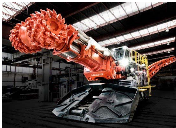
Fig. 37 – Escavadora equipadas com roçadora e tapete de carga ( www.rocktechnology.sandvik , 2018)
