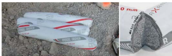
Fig. 59 – Explosivo tipo HIDROGEL (Alonso et al , 2013)
