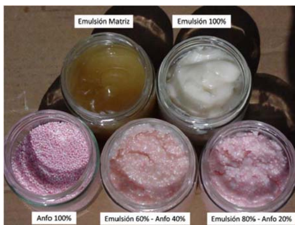
Fig. 60 – Diferentes tipos de emulsão em função da proporção emulsão/Anfo (Alonso et al , 2013)
