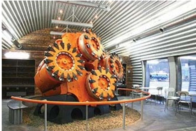
Fig. 10 – Máquina desenvolvida para perfuração do Túnel de Seikan ( www.princess.com )
