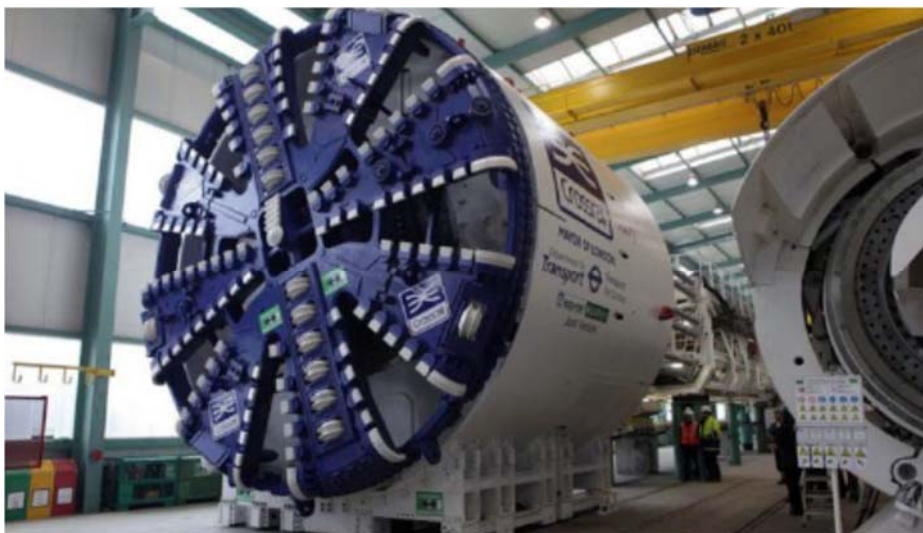
Fig. 114 – “Mary”, a SFM contruída para a escavação do Túnel “Water Lee” sob o rio Tamisa para o projecto “Crossrail”, Londres, Reino Unido (Nôro, 2014)
