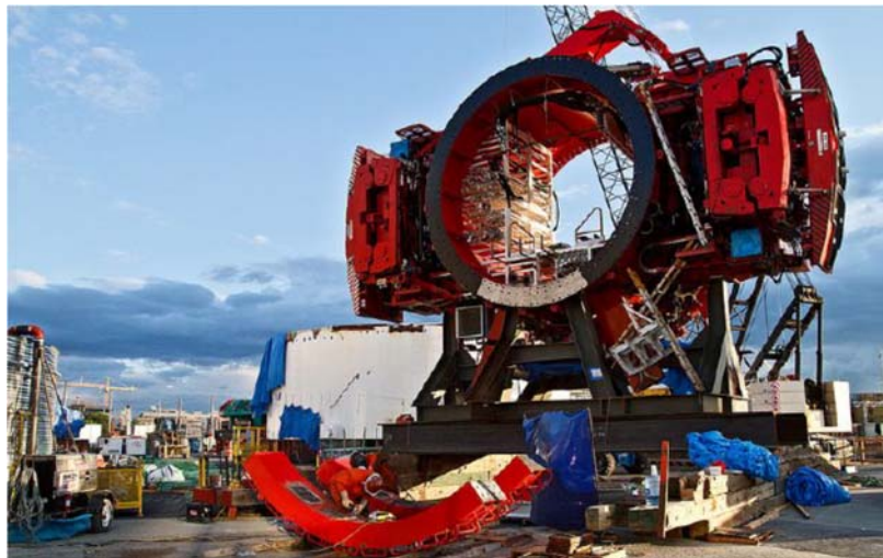
Fig. 97 – Eretor de dois braços da EPBM “Bertha” (Nôro, 2014)
