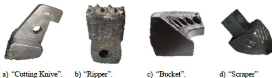
Fig. 99 – ferramentas de corte de aço de elevada resistência com liga de carbonato de tungsténio, HRC 75 - 80 (Nôro, 2018)
