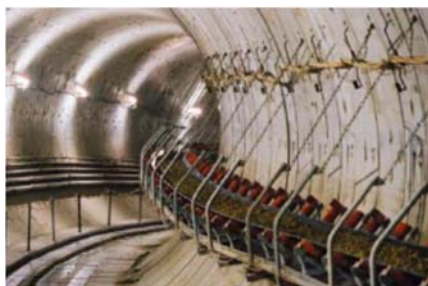
Fig. 100 – Transportador de correia desenvolvendo-se ao longo do alinhamento de um túnel ( www.herrenknecht.com , 2018)
