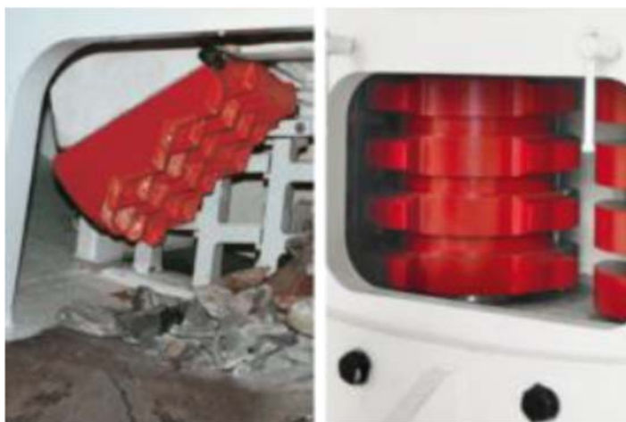
Fig. 116 – Trituradores de “Mandíbula” e de “Tambor” ( www.herrenknecht.com , 2018)
