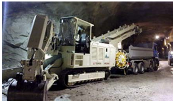
Fig. 36 – Escavadora equipadas com balde e tapete de carga ( www.mining-technology.com , 2018)
