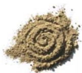
Fig. 113 – Bentonite sódica utilizada nas SFMs (Nôro, 2014)
