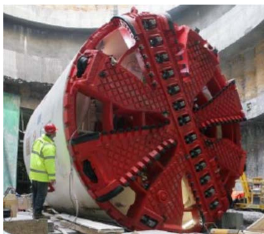
Fig. 106 – Cabeça de corte para um maciço alterado de uma Single Shield TBM (Nôro, 2014)
