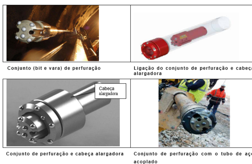
Fig. 41 – Tipos de bit e cabeça alargadora para furação com Jumbo (Félix, 2018)
