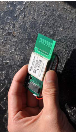
Fig.83- Sensor utilizado para rastrear objectos.
