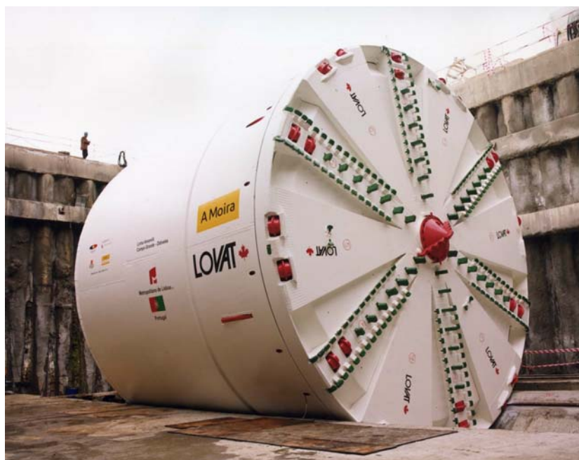
Figura 4.42 Fotografia da tuneladora usada na escavação do troço Campo Grande – Odivelas da Linha Amarela.
