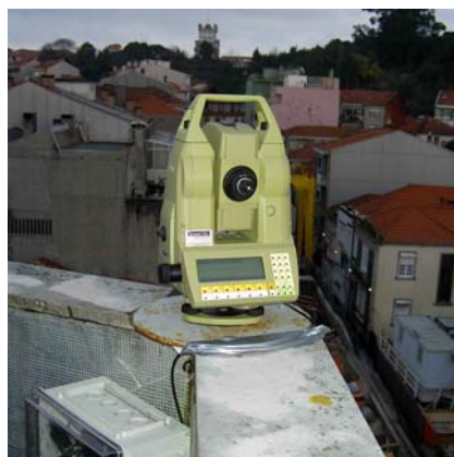
Figura 2.7 Estação total para leitura dos vários pontos objecto (Tecnasol FGE)
