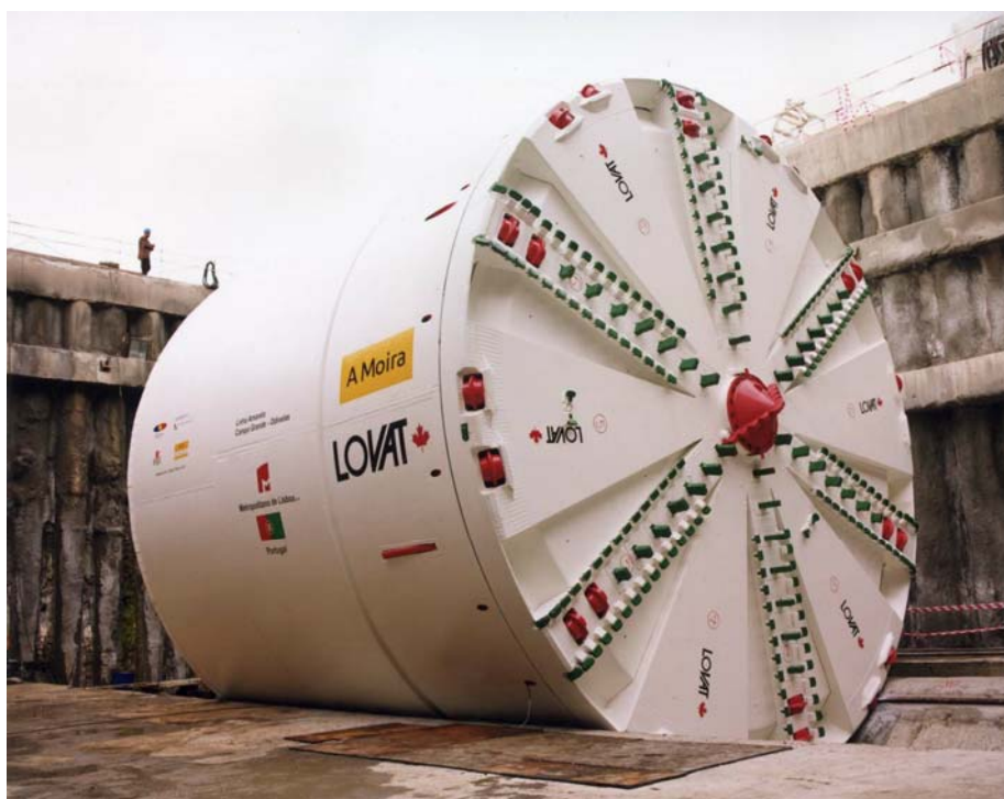
Figura 3.18 Tuneladora usada na escavação do troço Campo Grande – Odivelas (linha Amarela).
