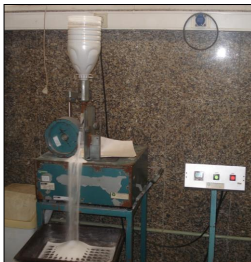
Figura 8.3- Máquina de desgaste de Capon. A substância branca a cair é o corindo, abrasivo usado neste ensaio.
