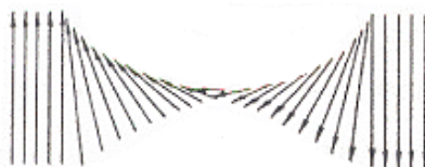
Figura 5.7- Rotação dos momentos magnéticos ao longo da Parede de Bloch (in Sant'Ovaia, 1993).
