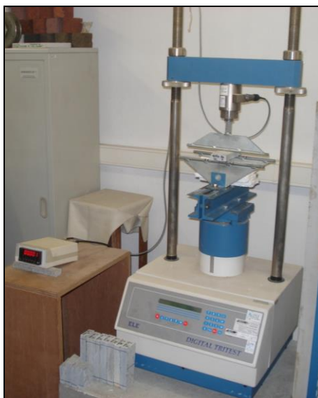
Figura 8.2- Tensómetro e dispositivo de aplicação de forças centradas, usados no ensaio da resistência à flexão sob carga centrada.
