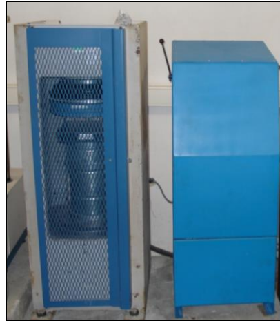
Figura 8.1- Prensa hidráulica utilizada para o ensaio da resistência à compressão.
