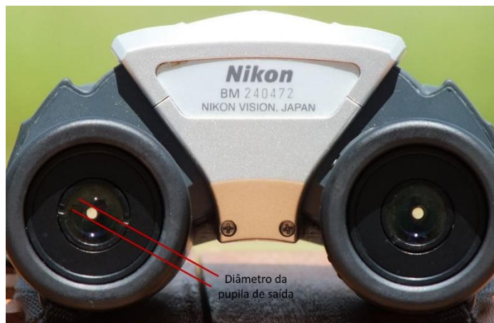
Figura 11 - Pupila de saída num binóculo, adaptado de Reviews (2018)
