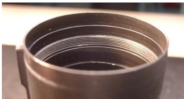
Figura 32 - Rosca do corpo do binóculo danificada
