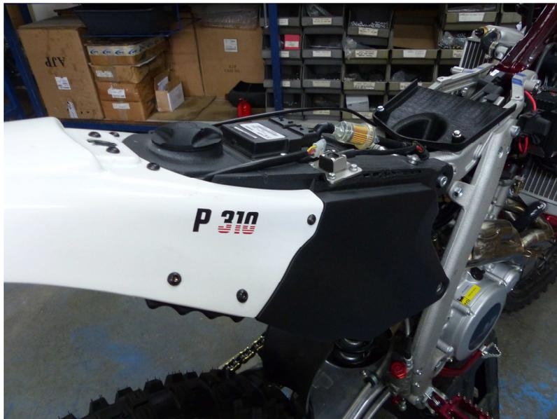
*Figura 9 Depósito inserido no protótipo P310 (Fonte própria)*
