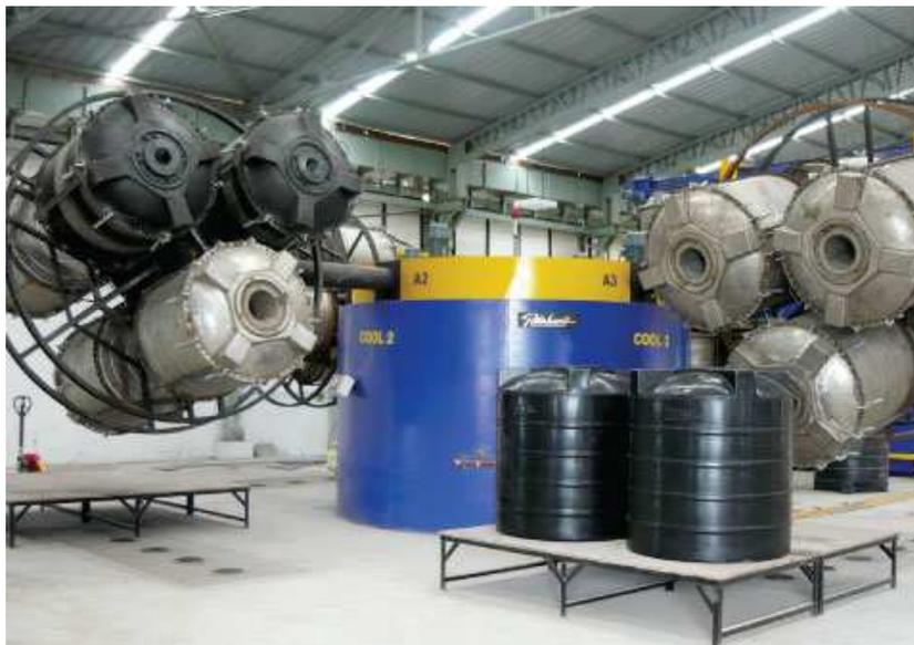
Figura 20 Máquina de roto-moldagem (Source:design1st.com)
