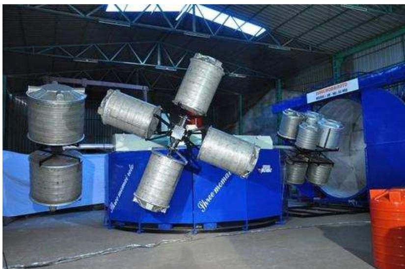
Figura 21 Máquina de roto-moldagem (Source: exportersindia.com)
