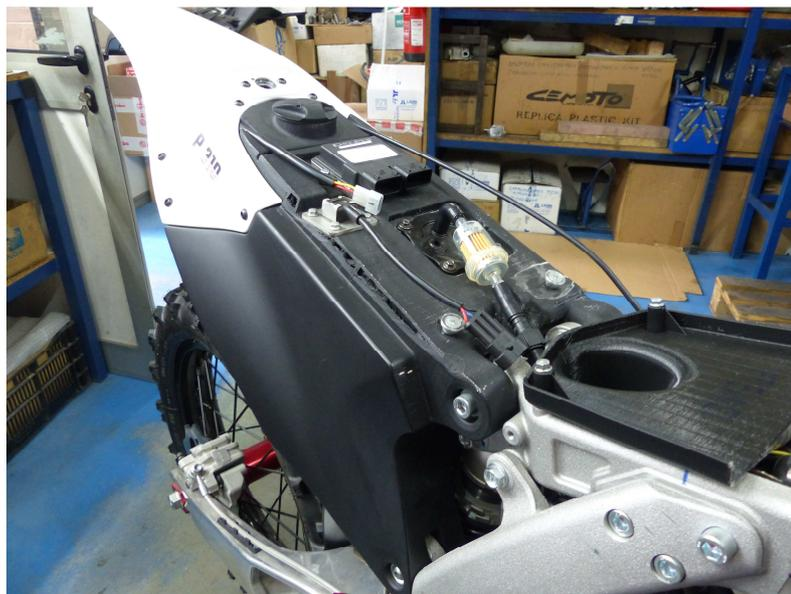
*Figura 10 Depósito inserido no protótipo P310 (Fonte própria)*
