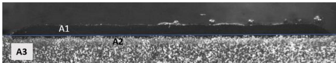
Figura 51 – Multicordões de 1 camada de Inconel 625 em GGG50.
