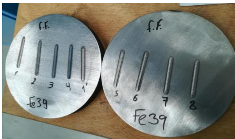
Figura 40 – Amostras de teste de GGG50 com cordões singulares de Fe 39.
