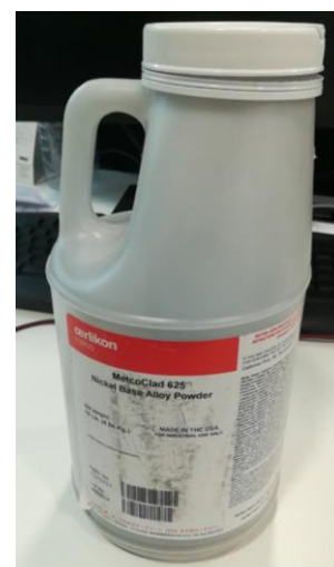
Figura 43 – Curvas de fluência do Inconel 625 (à esq.) (metco 2016) e embalagem de pó Inconel 625 usado na SERMEC - Wind Power (à dir.).
