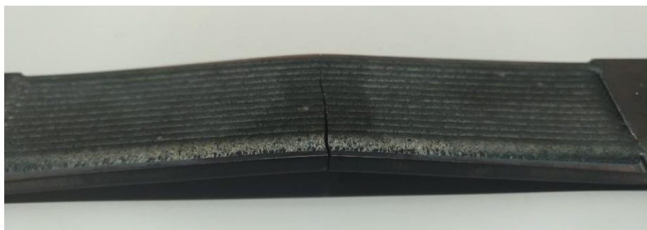
Figura 69 - Fenda central do provete de ferro fundido 4.
