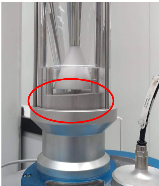
Figura 60 – Enchimento da panela de pó com Inconel 625 .
