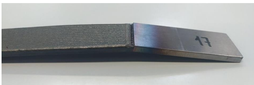
Figura 81 – Fenda na interface do provete de aço 17.
