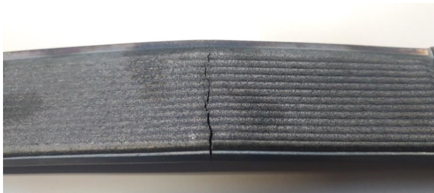
Figura 73 – Fenda central do provete de aço 8.
