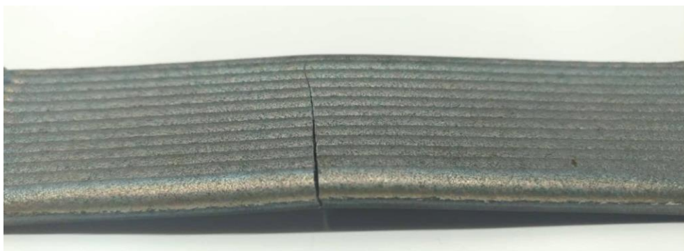
Figura 76 – Fenda central do provete de ferro fundido 11.
