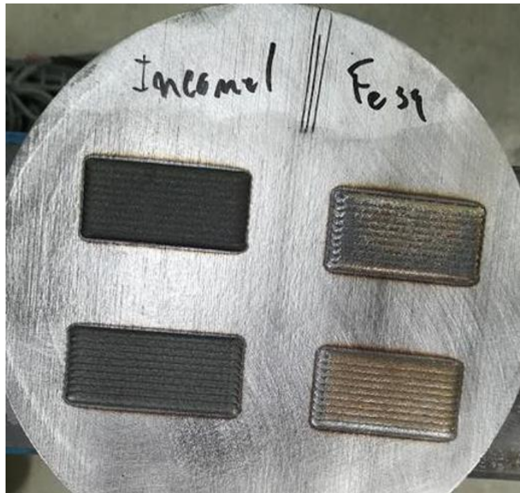
Figura 50 – GGG50 com multicordões de Inconel 625 (à esq.) e Fe39 (à dir.).
