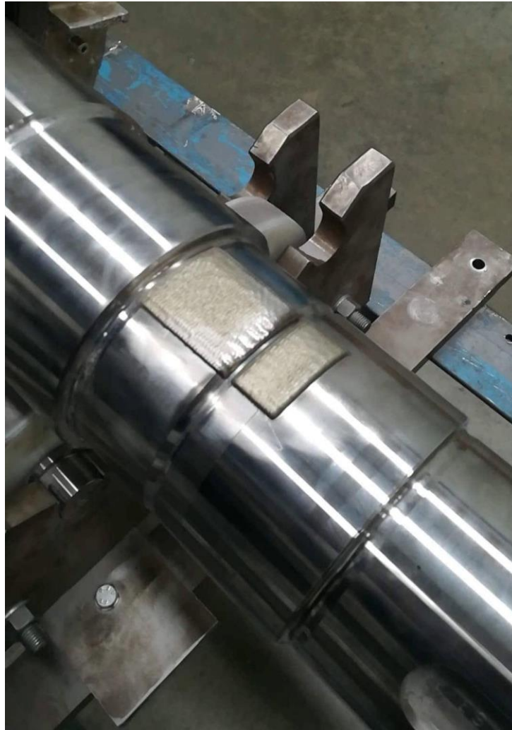
Figura 7 – Reparação de um main shaft na SERMEC Group .
