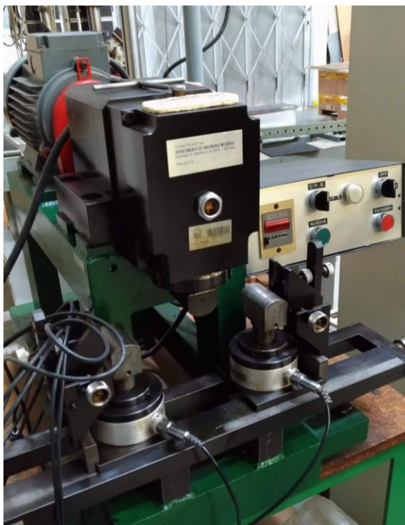
Figura 29 – Máquina de flexão em 3 pontos usada nos ensaios de fadiga.
