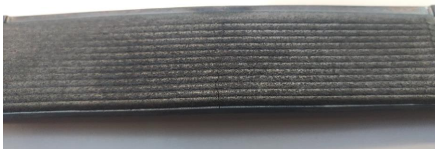
Figura 74 – Fenda central do provete de aço 9.
