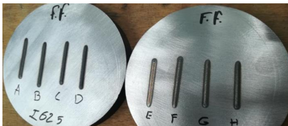
Figura 44 – Amostras de teste de GGG50 com cordões singulares de Inconel 625.
