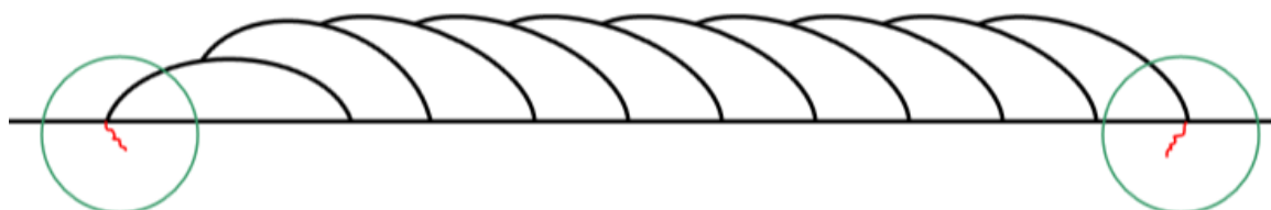
Figura 34 – Formação de fendas em camadas (Dierken 2013).
