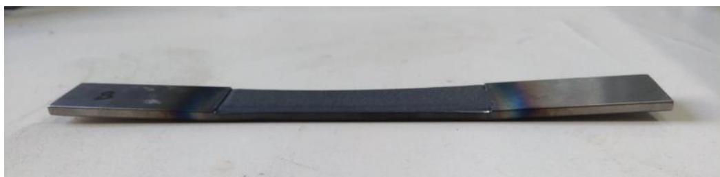
Figura 63 – Exemplo do empeno criado nos provetes de aço.
