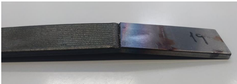
Figura 83 – Fenda na interface do provete de aço 19.
