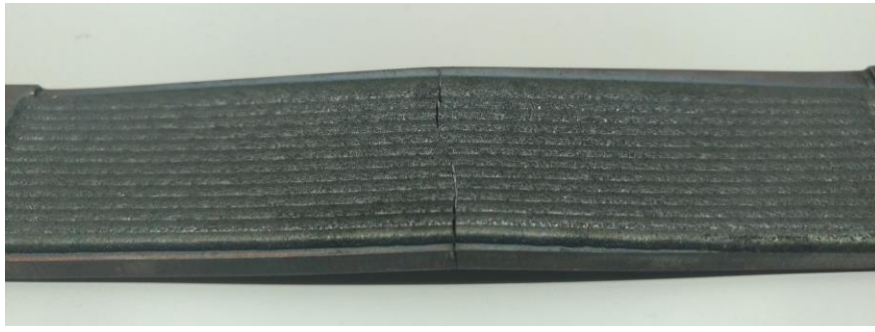
Figura 70 – Fenda central do provete de ferro fundido 5.
