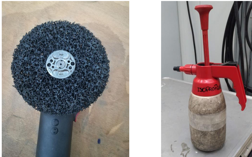
Figura 41 – Rebarbadora de disco negro (à esq.) e isopropanol, líquido de limpeza das amostras (à dir.).
