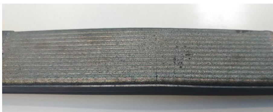
Figura 80 – Fenda central do provete de aço 16.
