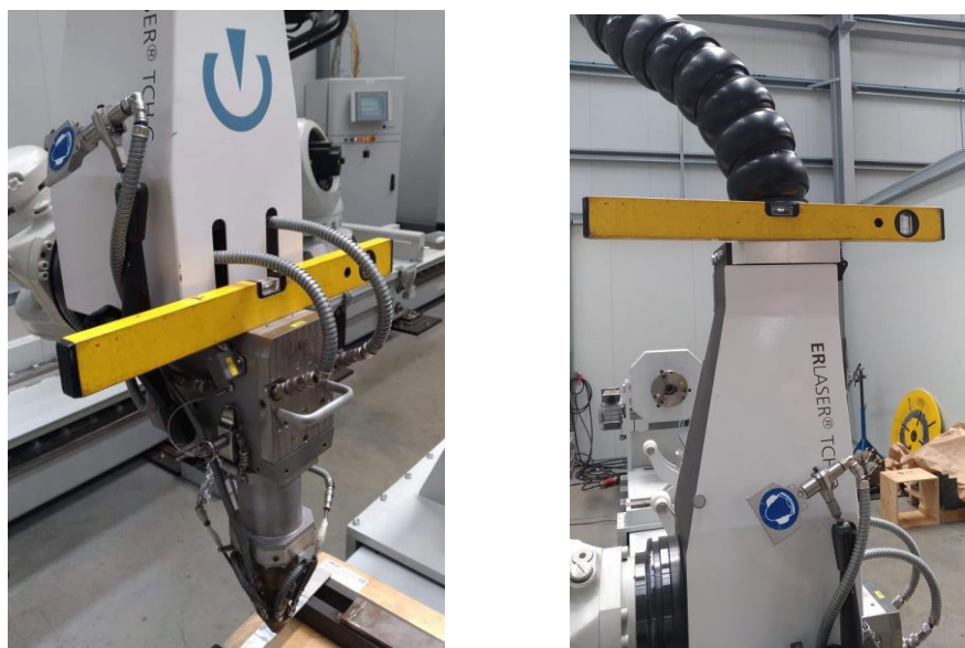
Figura 59 – Duas perspetivas de alinhamento dos eixos da máquina.
