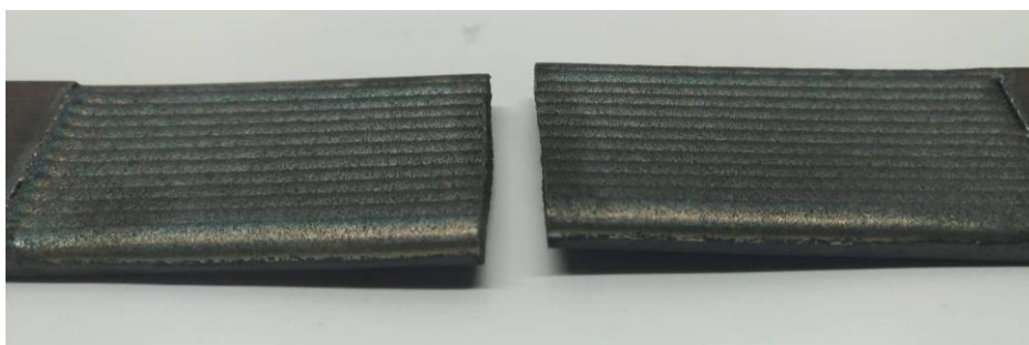
Figura 77 – Fenda central do provete de ferro fundido 13.
