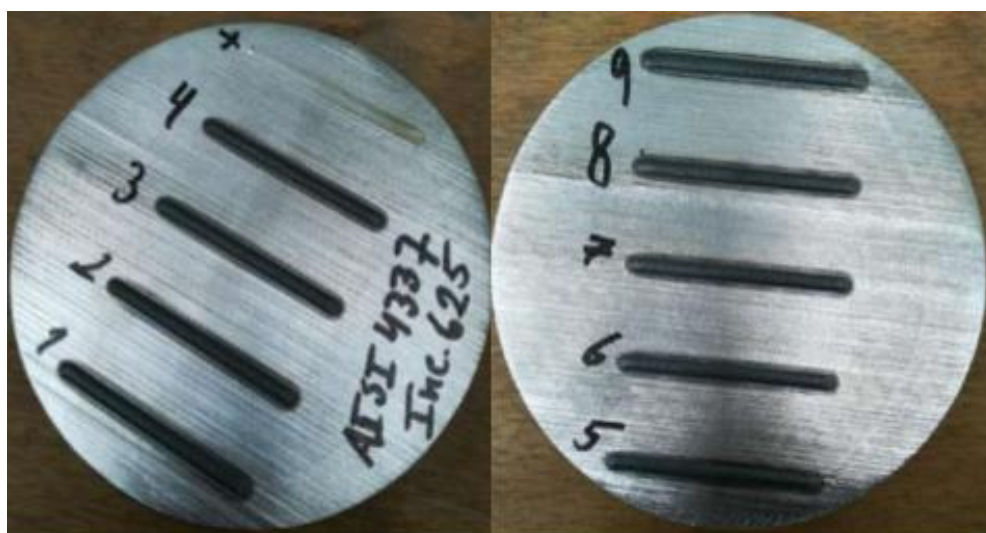
Figura 46 – Amostras de teste de AISI 4337 com cordões singulares de Inconel 625 .
