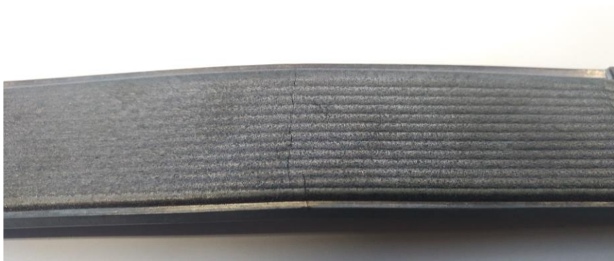
Figura 71 – Fenda central do provete de aço 6.
