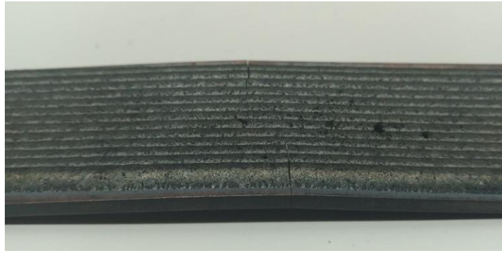
Figura 66 – Fenda central do provete de ferro fundido 1
