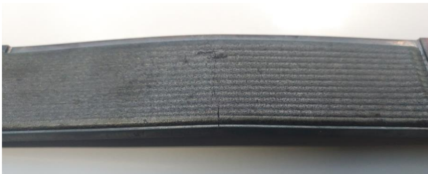
Figura 72 – Fenda central do provete de aço 7.
