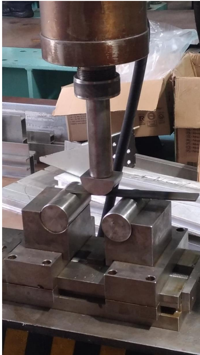
Figura 28 – Desempeno dos provetes com prensa hidráulica.
