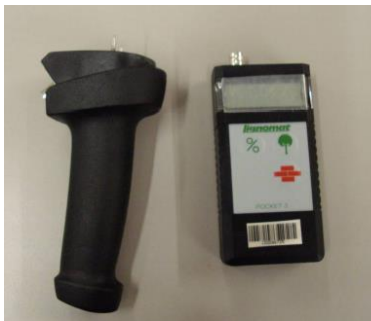
Fig. 3.14 – Equipamento baseado na corrente elétrica [28]
