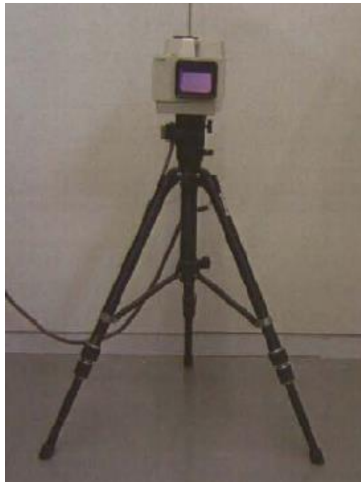
Fig. 3.19 – Equipamento para termografia (unidade de deteção) [30]
