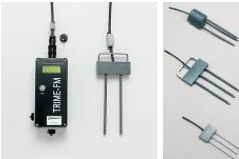
Fig. 3.18 – Equipamento TDR e sondas [28]
