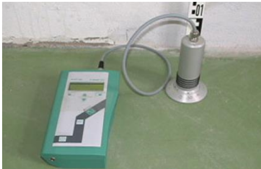
Fig. 3.16 – Equipamento baseado no método microondas [28]
