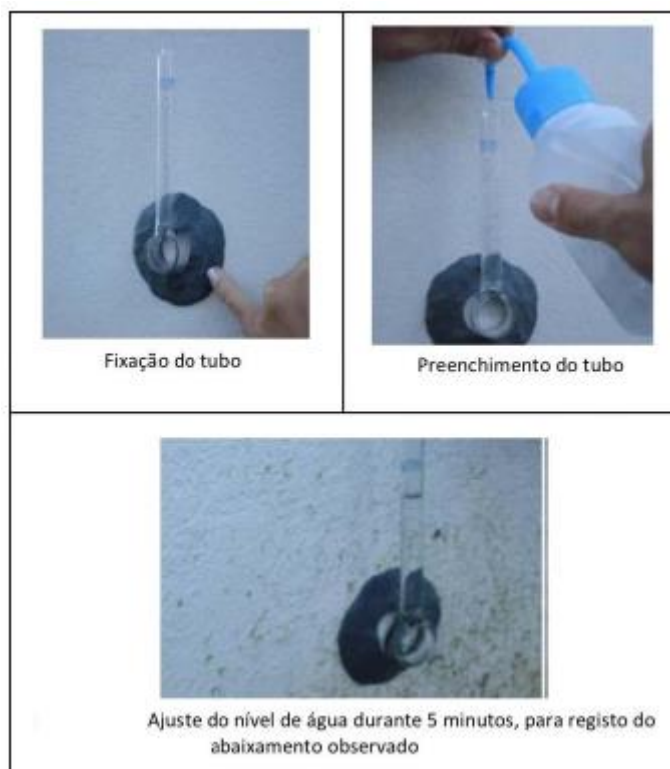
Fig. 3.10 - Procedimento do ensaio de absorção de água sob baixa pressão [27]
