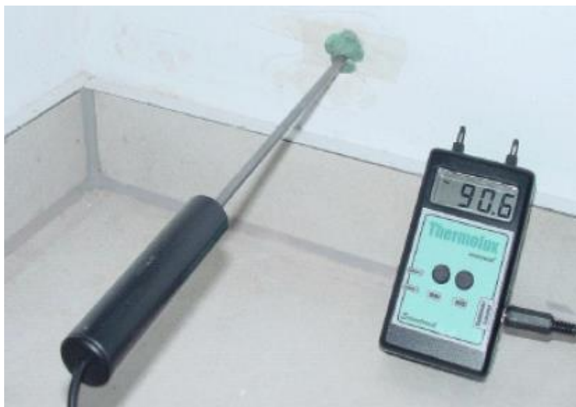
Fig. 3.22 – Equipamento baseado na medição da variação da impedância dum semicondutor [28]
