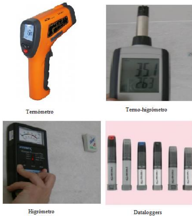
Fig. 3.11 - Equipamentos usados na técnica de registo e monitorização das condições higrotérmicas [27] [29]
