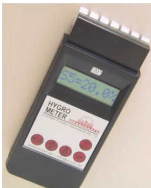
Fig. 3.15 – Equipamento baseado na constante dielétrica [28]
