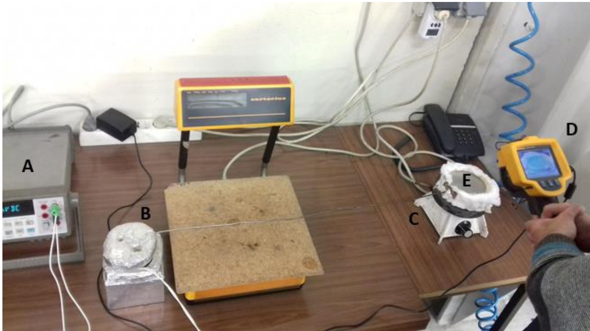
Figura 3-1 - Ensaio de medição da emissividade do disco em aço AISI 304.
