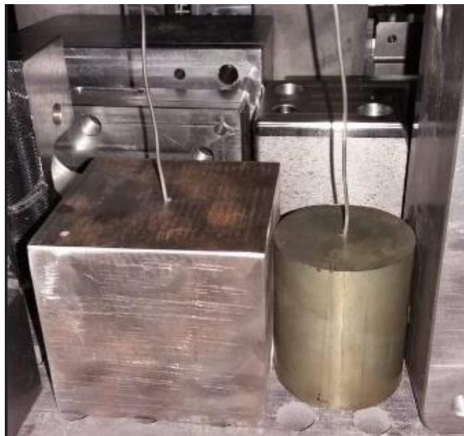
Figura 5-1 - Localização da peça de forma cúbica e respetivo bloco padrão cilíndrico na carga com termopares colocados nos seus núcleos.
