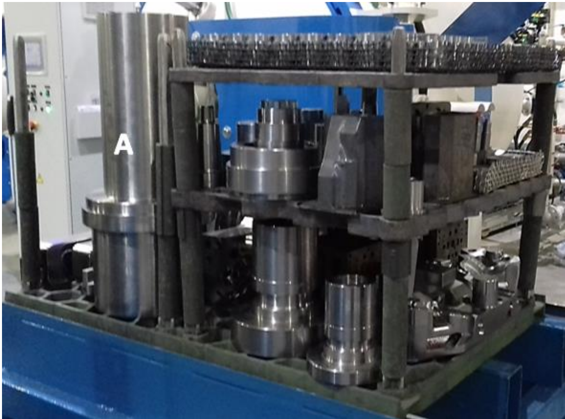
Figura 1-1 - Carga típica de aço H11 que irá ser submetida a um tratamento de têmpera.
