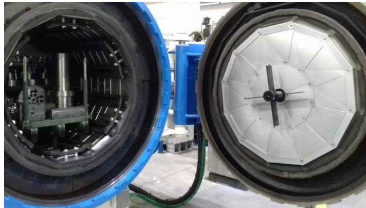
Figura 1-5 - Forno usado na empresa Ramada Aços S.A. com as resistências à volta das paredes do forno e com o ventilador da porta.
