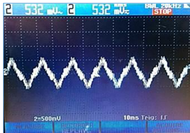
Figura 5.31 - Forma de onda f.e.m. induzida no veio obtida em ensaio ( W22X 355 4np )
