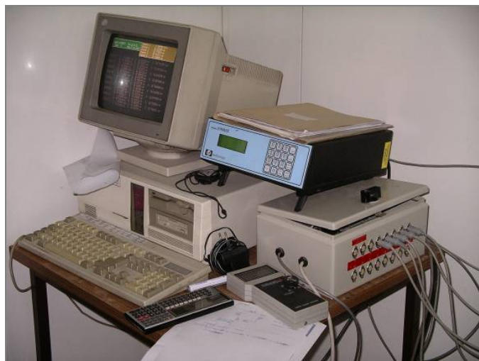
Figura 3.38 - Sistema de registo e aquisição das unidades de força e deslocamento.
