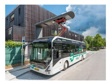
Figura 2.15: Exemplo de uma paragem de autocarro com um sistema de carregamento baseado num pantógrafo [53]
