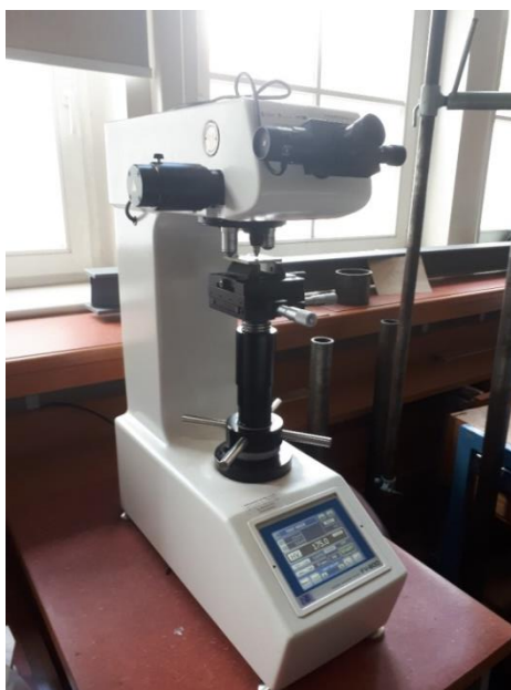
Figura 4.14 - Ensaio de dureza Vickers usado na investigação de material.
