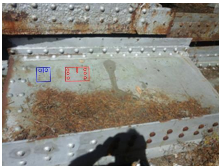
Figura 4.6 – Orientação usada em função da geometria dos provetes CT e CTS.
