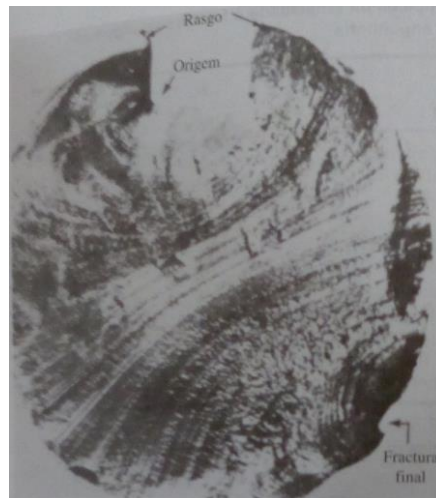
Figura 2.1 - Superfície de fratura por fadiga de um veio de aço 1040. A fenda de fadiga iniciou-se no canto inferior esquerdo do escatel e propagou-se praticamente através de toda a seção reta antes de ocorrer a rotura final [8].
