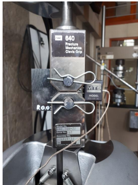
Figura 4.26 – Provete CT durante o ensaio de taxas de propagação de fendas de fadiga ( R = 0.05 ).
