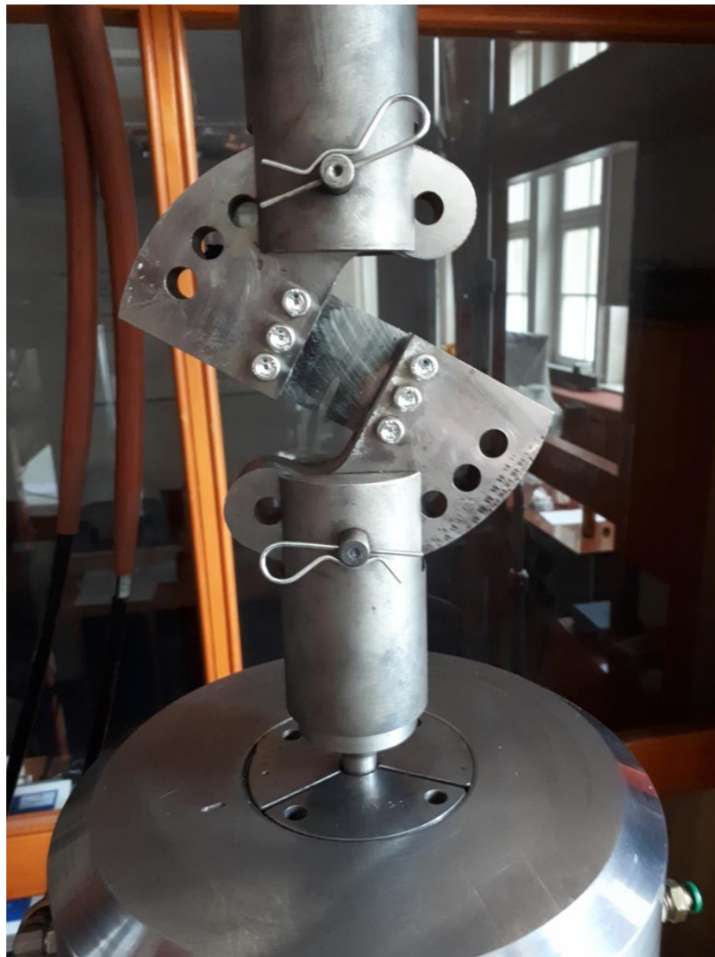
Figura 4.40 - Dispositivo de carga configurado para condição em modo misto - ângulo de carga de 60 °.
