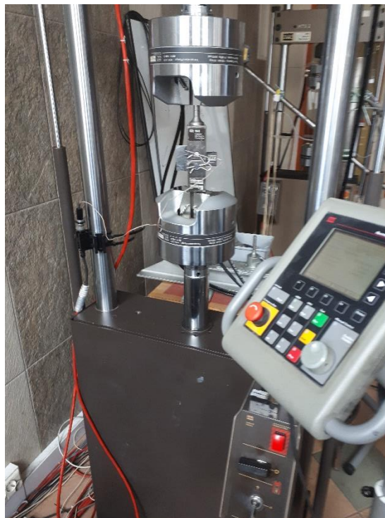
Figura 4.25 - Máquina de ensaio MTS810 com sistema de aperto adicional.
