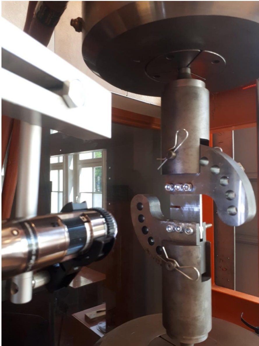
Figura 4.39 - Dispositivo de carregamento configurado no modo I - procedimento de pré-fenda.
