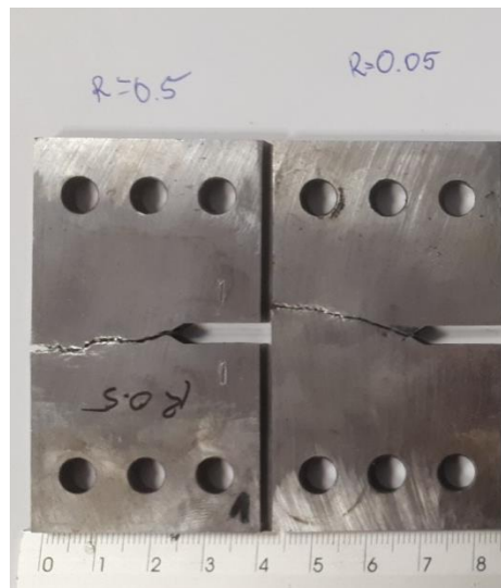
Figura 4.41 - Provete CTS colapsado após ensaio de crescimento de fenda por fadiga em modo misto - ângulo de carregamento de 30 °.
