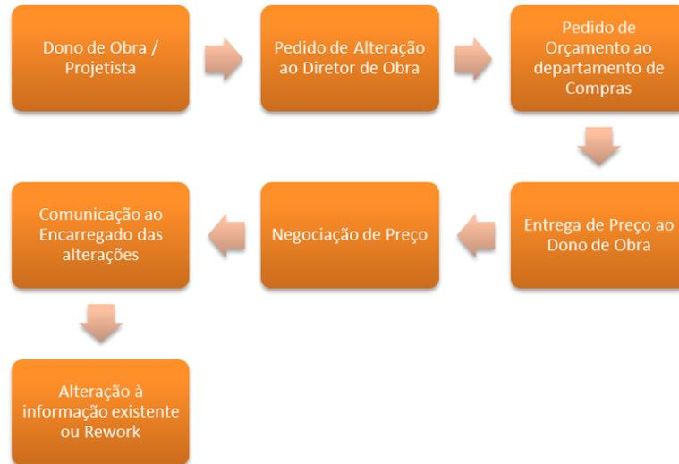
Figura 4.4 – Fluxograma de Alteração de Projeto pelo D.O.
