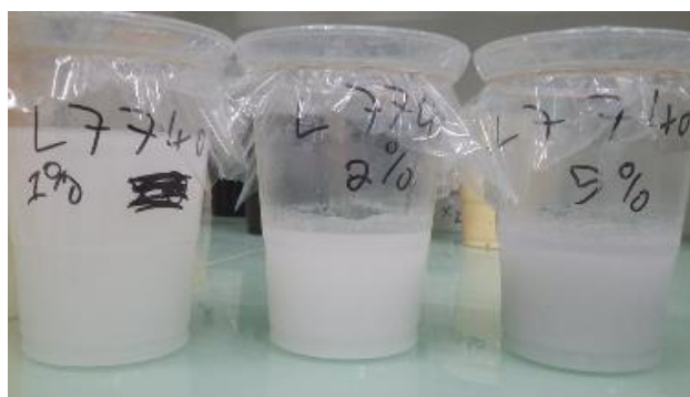
Figura 16 - Fotografia das lacas solvente produzidas em laboratório com incorporação de zeólitos. É visível o escurecimento da laca com o aumento de concentração.
