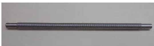
Figura 7 - Fotografia da vareta usada na lacagem dos artigos.
