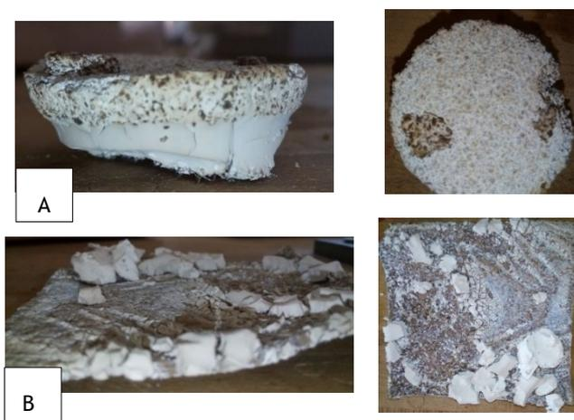
**Figura 36** - *Imagens representativas dos protótipos preparados: A- Manta de aerogel com cortiça; B- Painel sanduíche preparado pelo procedimento 2.*
