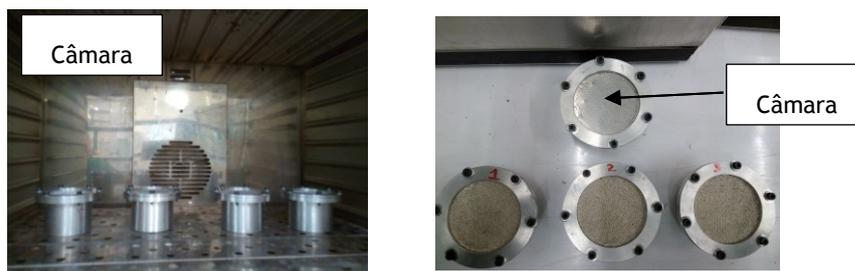
**Figura 8** - Instalação experimental para ensaios de permeabilidade ao vapor de água.
