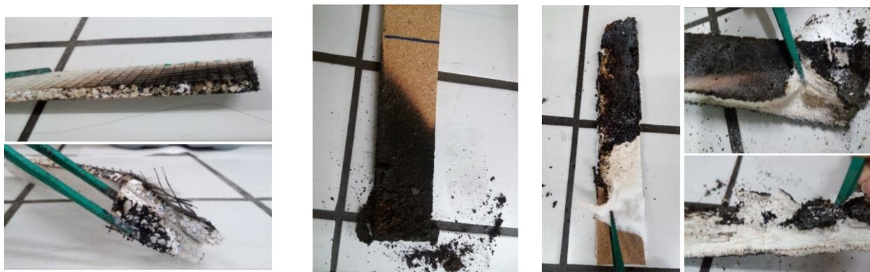
*Figura 21- Imagem representativa do interior de cada painel após a exposição de cada um durante 30 segundo a pequena chama.*
