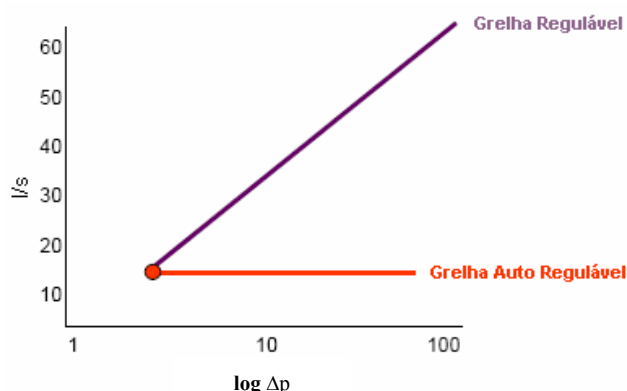
Figura 2-10 - Comparação entre o caudal debitado por uma grelha regulável e uma grelha auto-regulável
