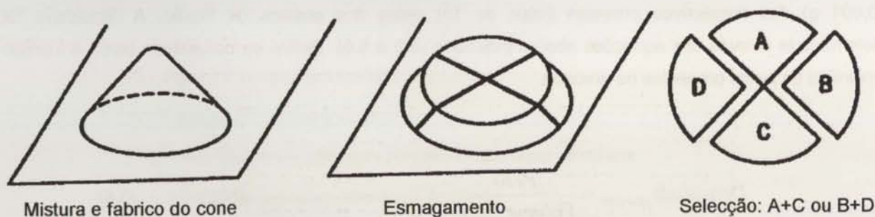
Figura 5.4 – Procedimento para obtenção de amostras para ensaios de análise granulométrica (Pope e Ward, 1998).
