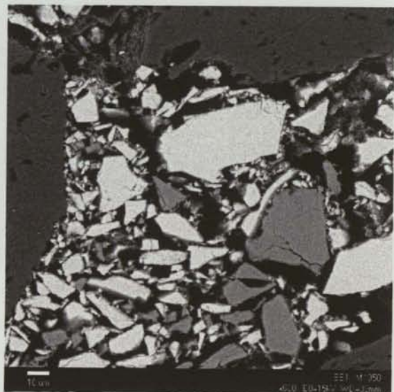
Figura 6.96 - Microestrutura de amostra da mistura M sinterizada a 1050 °C/2 h. As zonas mais escuras correspondem à porosidade (vermelho da figura 6.95), as mais claras ao silicato de zircónio e as intermédias à molochite.
