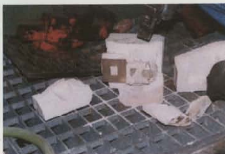
g) Ferramenta metálica obtida ainda agarrada à moldação cerâmica.
