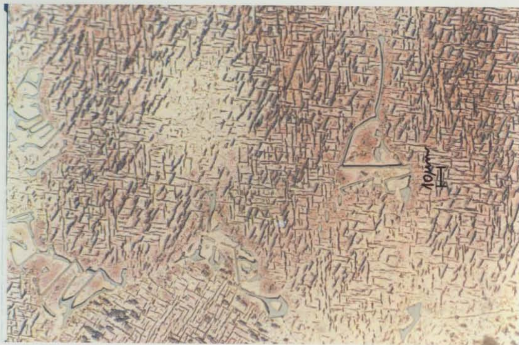
Figura 7.35 - Microestrutura da liga CIFIAL após vazamento. Ampliação 500x.
