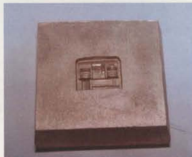
h) Ferramenta metálica após corte dos sistemas de alimentação e gitagem.
