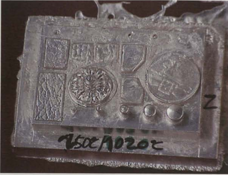
Figura 7.2 – Ferramenta metálica obtida nas seguintes condições de vazamento: temperatura de vazamento 1020 °C e temperatura de pré-aquecimento da moldação cerâmica 150 °C. Ausência de definição de pormenores devido ao arrefecimento rápido do metal.
