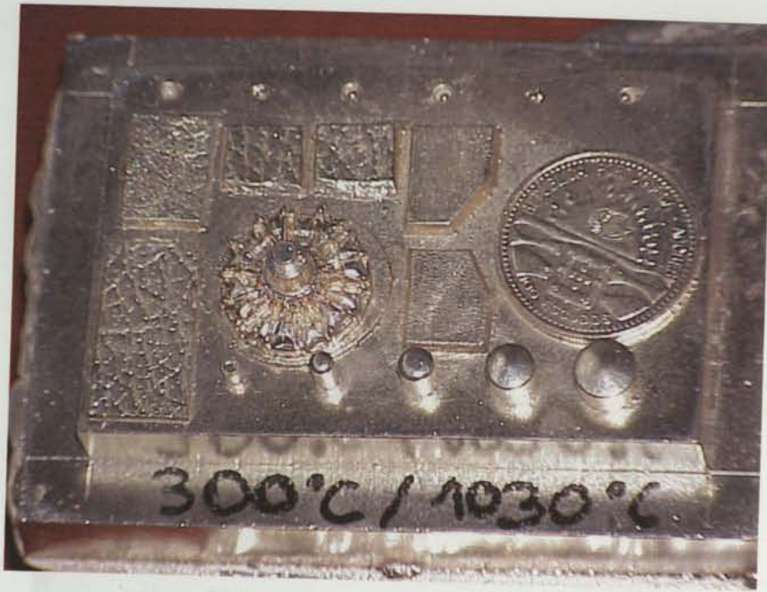
Figura 7.10 – Ferramenta metálica obtida nas seguintes condições de vazamento: Temperatura de pré-aquecimento da moldação cerâmica - 300 °C e temperatura de vazamento da liga de Cu-Be - 1030 °C. Pormenores bem reproduzidos.
