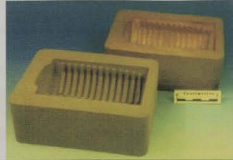
Figura 2.12 – Dois exemplos de ferramentas de injeção de plásticos obtidas pelo processo TDP (www.prometal.com).
