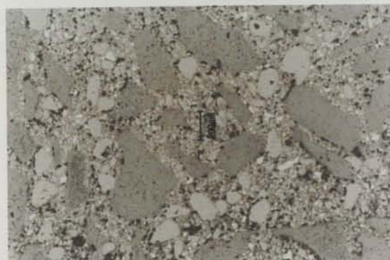
Figura 6.86 - Microestrutura de amostra da mistura M queimada e sinterizada - 750 °C/2 h. Ampliação 30 x.
