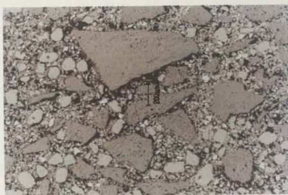
Figura 6.83 - Microestrutura de amostra da mistura M verde (sem tratamento térmico). Ampliação 30 x.
