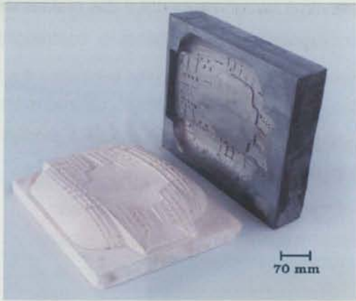
Figura 2.22 – Moldação cerâmica e respectiva cavidade metálica (em zamak).
