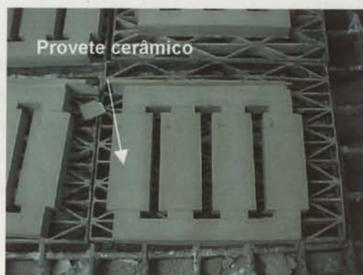
d) 4 provetes cerâmicos após desmoldação, sobre placas em aço inoxidável planas para evitar empenos durante a fase de queima. Os provetes ainda estão ligados através do sistema de alimentação, o qual será em seguida cortado.
