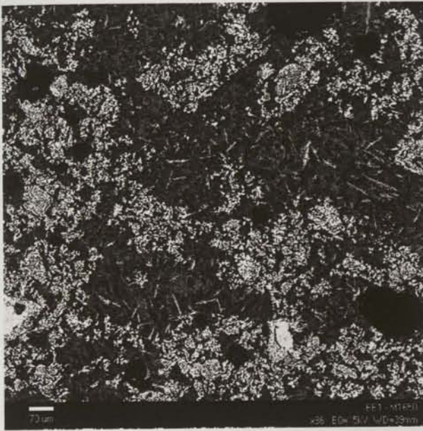
Figura 6.108 - Microestrutura de amostra da mistura M sinterizada a 1650 °C/2 h. Ocorreu fusão total da amostra, daí o aspecto dendrítico que esta apresenta.
