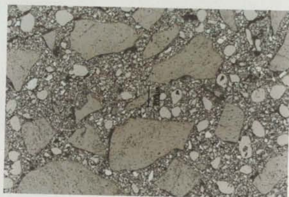
Figura 6.62 - Mistura K: 15% SZ -325 + 30% SZ - 200 + 15% SZ Areia + 20% Mol 30/80 + 10% Mol 16/30 + 10% Rut -200. Ampliação 30 x.
