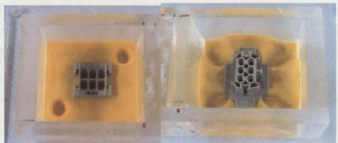
b) Modelo dentro de uma caixa em acrílico. O silicone será vazado para dentro desta caixa. A plasticina amarela define o plano de separação.
