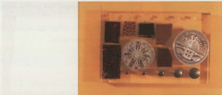
a) Modelo original, com base em acrílico e peças de formas intrincadas (bocados de couro, motor em plástico de um kit de avião e moeda "proof", para avaliação da capacidade de reprodução de detalhes do processo (100x60x10 mm).
