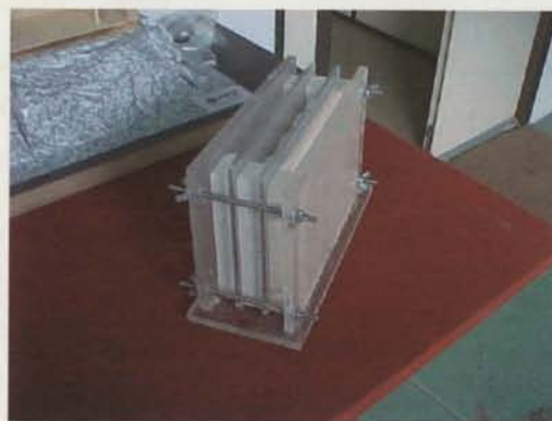
b) Caixa para obtenção de 12 provetes para ensaios de flexão. A barbotina é vazada por cima.
