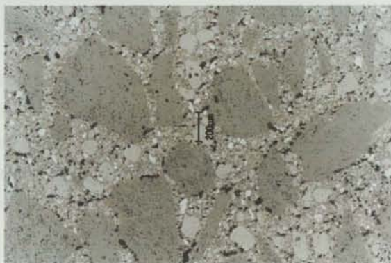
Figura 6.87 - Microestrutura de amostra da mistura M queimada e sinterizada - 900 °C/2 h. Ampliação 30 x.
