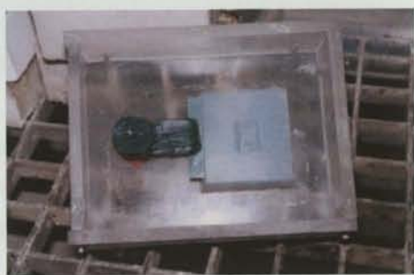
a) Modelo em silicone, com o sistema de alimentação e gitagem em cera.
