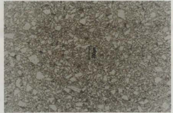
Figura 6.55 - Mistura D: 40% Mol -200 + 60% Mol -120. Ampliação 30 x.
