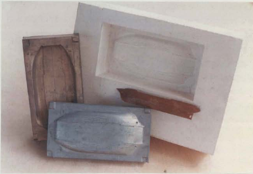
Figura 3.13 – Moldação cerâmica (atrás) idêntica à que deu origem à cavidade em Cu-Be (ao alto), bucha metálica em zamak (à frente) e respectiva peça plástica injectada no conjunto.
