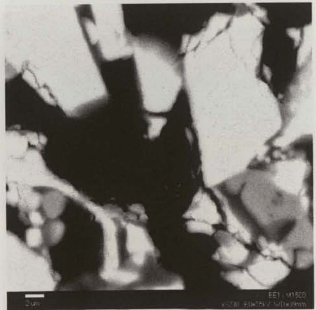
Figura 6.103 - Microestrutura de amostra da mistura M sinterizada a 1500 °C/2 h. É visível alguma ligação entre partículas (desvanecimento dos limites das partículas e formação de colos).
