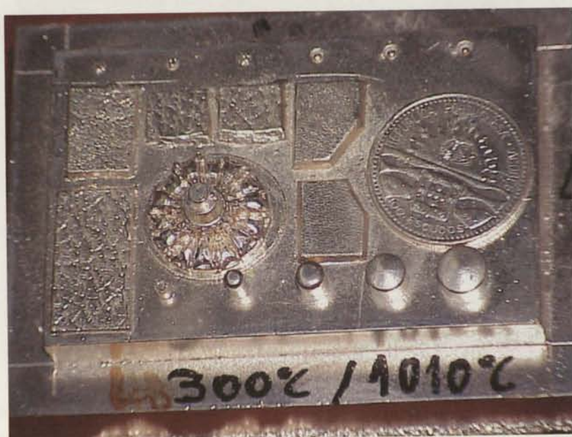
Figura 7.9 – Ferramenta metálica obtida nas seguintes condições de vazamento: Temperatura de pré-aquecimento da moldação cerâmica - 300 °C e temperatura de vazamento da liga de Cu-Be - 1010 °C. Pormenores bem reproduzidos e aspecto brilhante.
