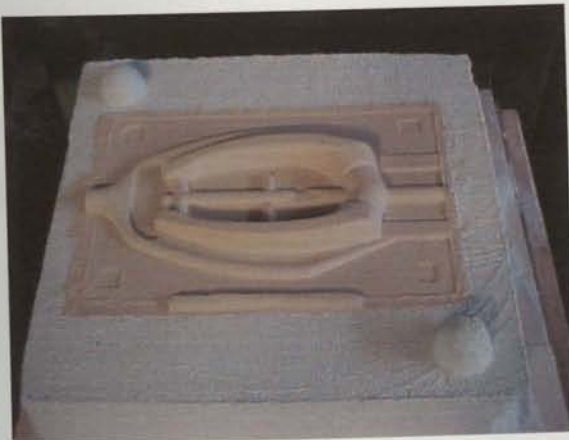
Figura 3.11 – Moldação compósita. No centro pode observar-se a zona que vai dar origem à ferramenta metálica (obtida através do vazamento de uma barbotina) envolvida por uma zona mais clara (chamote misturada com silicato de sódio e endurecida com \text{CO}_2 ).
