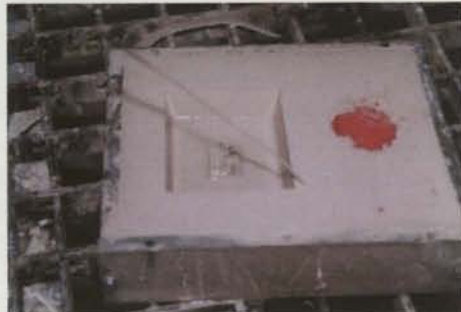
d) Estabilização da moldação cerâmica por pulverização com álcool etílico.
