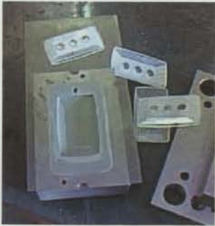
Figura 2.19 – Peças em plástico injectado e o respectivo molde (cavidade e bucha) obtido por vazamento de uma resina reforçada com pós metálicos (Alves et al., 2001).
