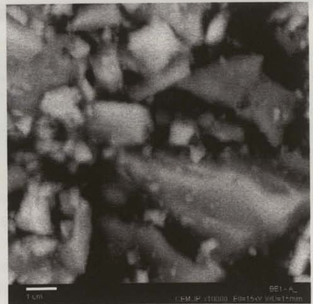
Figura 6.109 - Microestrutura de amostra da mistura M sinterizada a 1650 °C/2 horas. Pormenor da figura anterior a maior ampliação.
