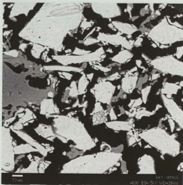
Figura 6.104 - Microestrutura de amostra da mistura M sinterizada a 1500 °C/2 h. É bem visível a ligação entre partículas.
