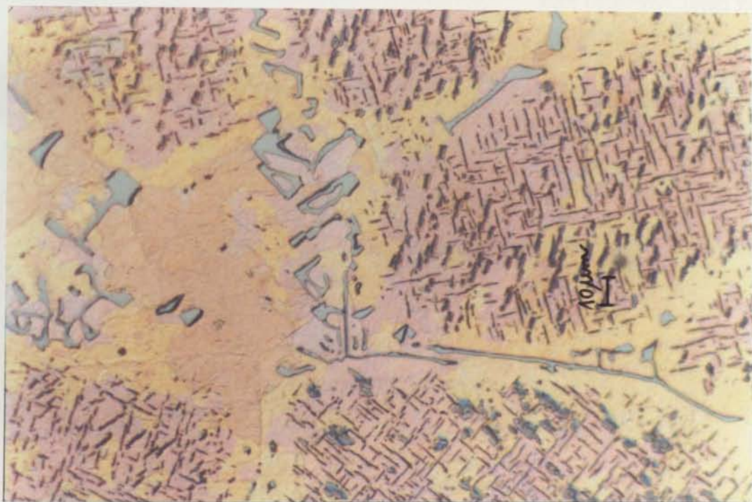
Figura 7.36 - Microestrutura da liga CIFIAL após vazamento e homogeneização. Não há grandes diferenças em relação à microestrutura da figura anterior. Ampliação 500x.
