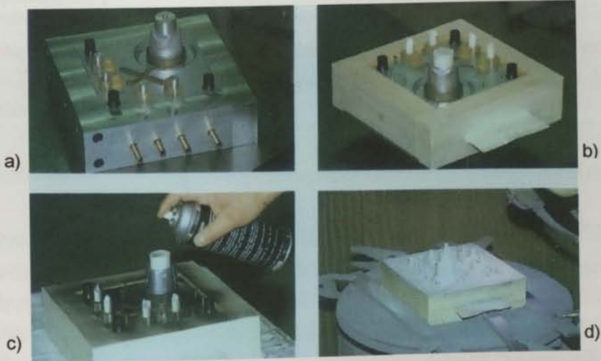
Figura 2.31 – Algumas etapas do processo de fabrico de uma ferramenta por spray metálico (Zajicek, 1997).
