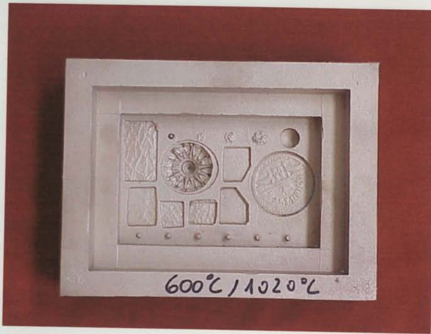
Figura 7.14 – Ferramenta metálica obtida nas seguintes condições de vazamento: Temperatura de pré-aquecimento da moldação cerâmica - 600 °C e temperatura de vazamento da liga de Cu-Be - 1020 °C. Pormenores bem reproduzidos.
