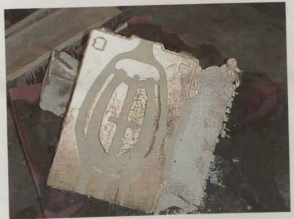
Figura 3.12 – Coquilha (para obtenção de torneiras por vazamento de latão) obtida através do vazamento de Cu-Be na moldação da figura anterior, ainda com algum material da moldação cerâmica a ela agarrada.
