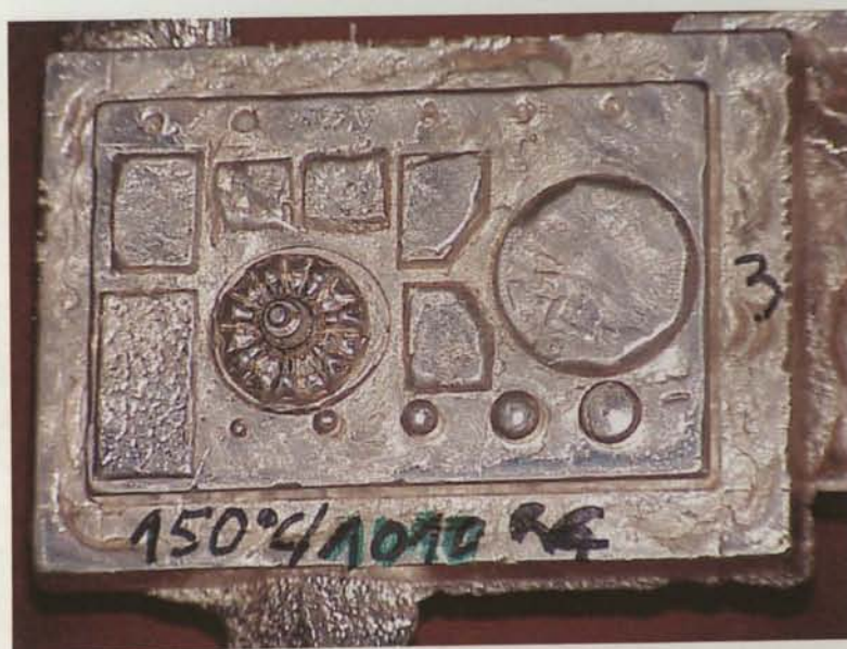
Figura 7.1 – Ferramenta metálica obtida nas seguintes condições de vazamento: temperatura de vazamento 1010 °C e temperatura de pré-aquecimento da moldação cerâmica 150 °C. Ausência de definição de pormenores devido ao arrefecimento rápido do metal.
