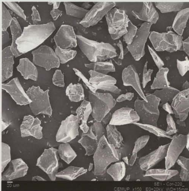
Figura 5.33 – Partículas de farinha de corindon 220.
