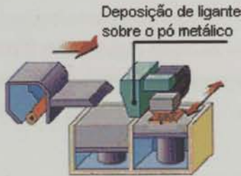
Impressão do ligante sobre o pó metálico nas zonas que constituem a peça.
