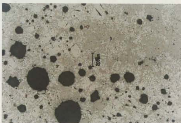
Figura 6.92 - Microestrutura de amostra da mistura M queimada e sinterizada - 1650 °C/2 h. Os círculos pretos são poros. Ampliação 30 x.
