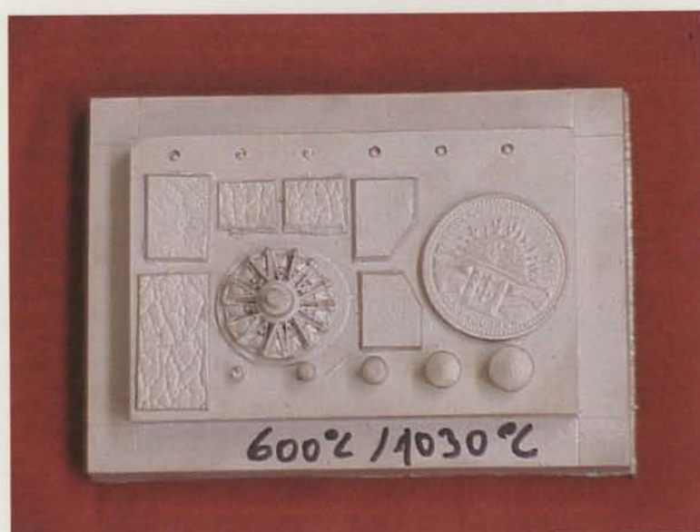
Figura 7.12 – Ferramenta metálica obtida nas seguintes condições de vazamento: Temperatura de pré-aquecimento da moldação cerâmica - 600 °C e temperatura de vazamento da liga de Cu-Be - 1030 °C. Pormenores bem reproduzidos.
