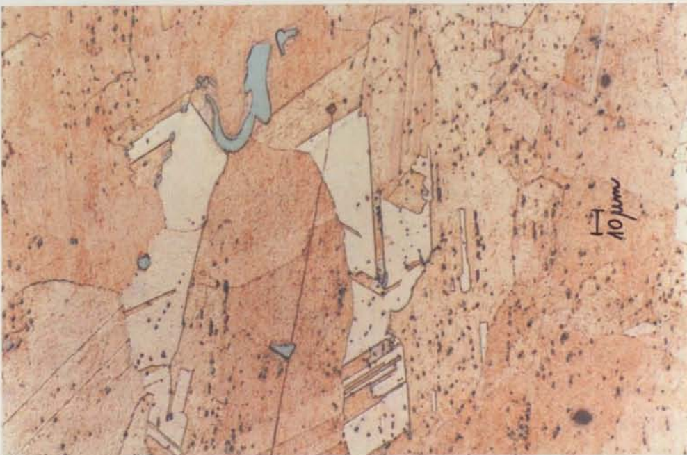
Figura 5.40 – Microestrutura de liga de maquinagem (aproveitamento de coquilhas de vazamento de latão em desuso). Matriz constituída por grãos alongados de fase \alpha (a forma dos grãos é resultante do processo de fabrico, a laminagem) e berilides (compostos de Be/Ni/Co) (de cor azulada) dispersas pela matriz.
