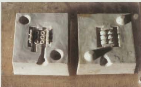
c) Modelo em silicone obtido após cura e desmoldagem da caixa da figura anterior (3.4 b) do lado esquerdo). Estes modelos serão colocados dentro de caixas e vão dar forma às moldações cerâmicas.
