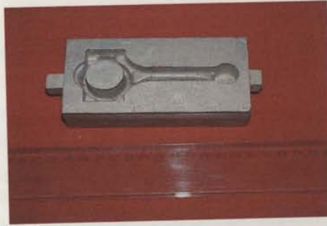
Figura 2.24 – Ferramenta metálica (comprimento cerca de 140 mm) obtida por vazamento de uma liga de alumínio numa carapaça cerâmica. O modelo (em LOM) foi queimado e, portanto, perdido.
