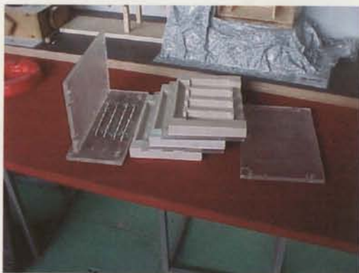
a) Caixa em acrílico e moldes em silicone para obtenção de provetes para ensaios de flexão (desmontada).
