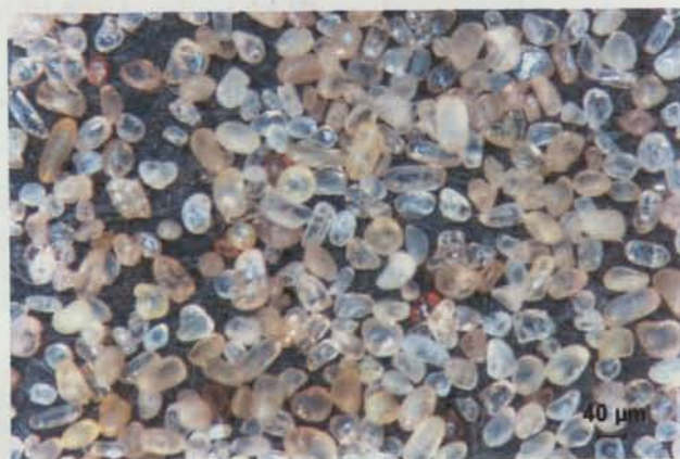
Figura 5.22 – Partículas arredondadas de areia de silicato de zircónio.
