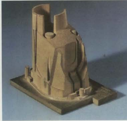
Figura 2.10 – Macho para obtenção de uma ferramenta metálica por fundição. É considerado um processo directo pois o macho funciona como uma ferramenta (EOS, 1995).
