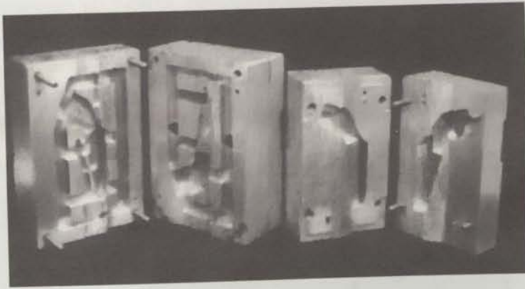
Figura 2.25 – Ferramentas metálicas obtidas por vazamento em carapaças cerâmicas (Hilton e Jacobs, 2000).
