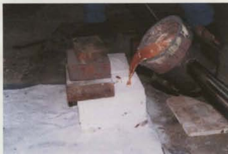
f) Vazamento de uma liga Cu-Be sobre a moldação cerâmica.
