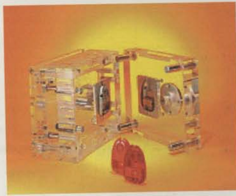
Figura 2.27 – Inserts obtidos pelo processo Keltool, colocados numa estrutura de um molde demonstrativo, com as respectivas peças plásticas obtidas por injeção ( www.3dsystemns.com ).
