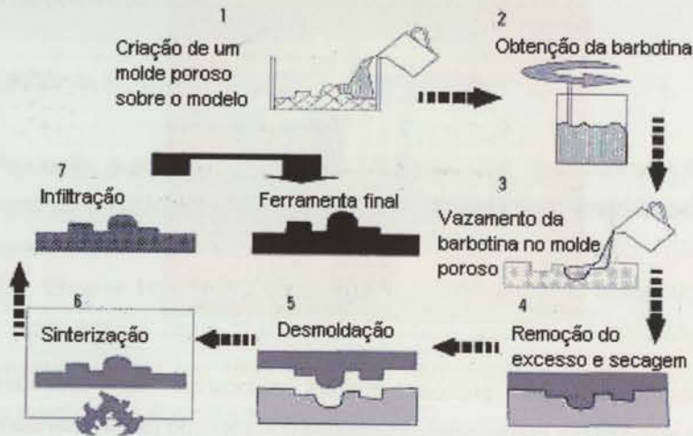
Figura 2.28 – Sequência de processamento do fabrico de ferramentas por “slip casting” (Ainsley e Gong, 1999).
