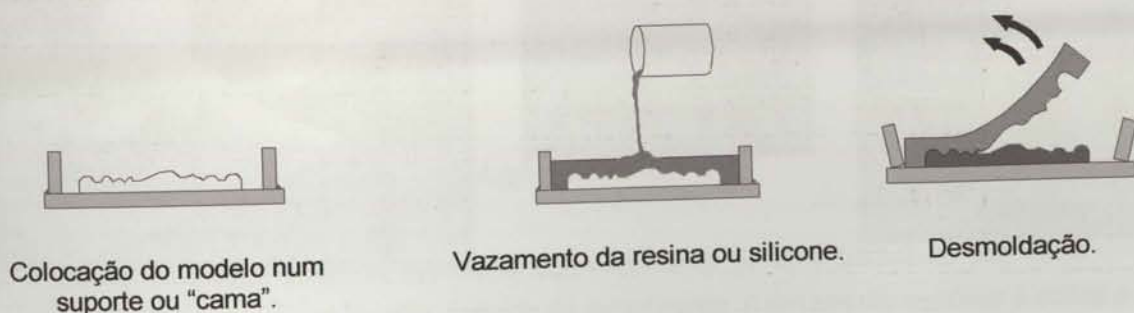
Figura 2.16 - Sequência de fabrico de metade de uma ferramenta por vazamento de uma resina ou silicone (Alves et al., 2001).
