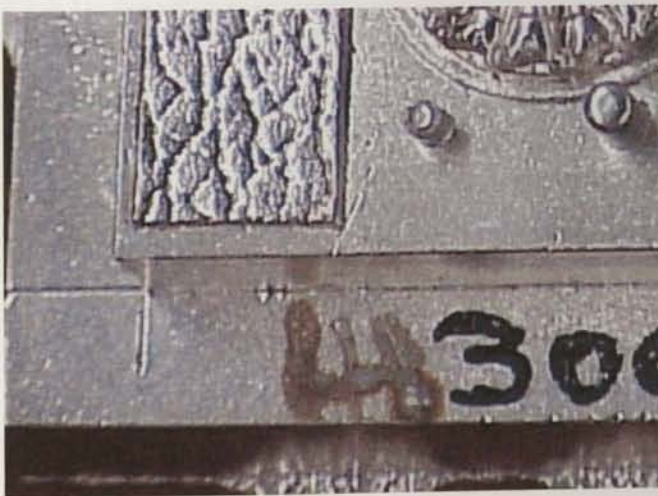
Figura 7.17 – Pormenor da reprodução de esquina viva do modelo da figura 5.9, página 175/176.
