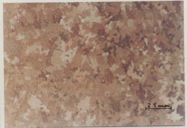
Figura 7.5 – Macroestrutura de amostra obtida após vazamento em moldação cerâmica: pré aquecimento - 600 °C e temperatura de vazamento - 1020 °C. Ampliação 5x.
