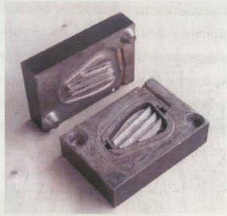
Figura 2.23 – Ferramenta em Cu-Be, para injeção de peça de ventilação de automóvel em plástico, obtida através de moldações cerâmicas.
