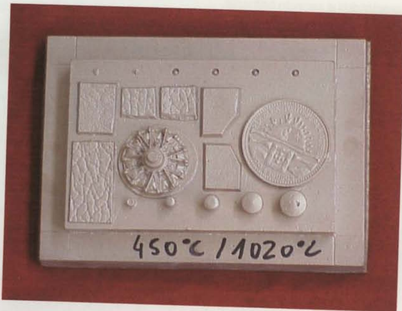
Figura 7.11 – Ferramenta metálica obtida nas seguintes condições de vazamento: Temperatura de pré-aquecimento da moldação cerâmica - 450 °C e temperatura de vazamento da liga de Cu-Be - 1020 °C. Pormenores bem reproduzidos.
