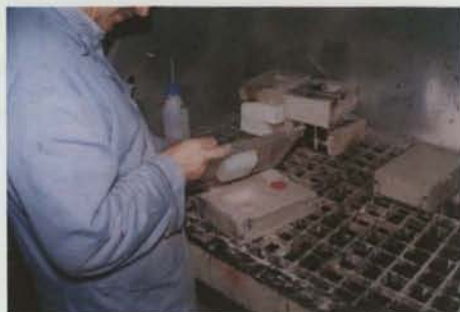
c) Desmoldação – separação entre o modelo e a moldação cerâmica.
