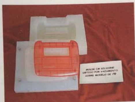
Figura 2.17 – Ferramenta em silicone e protótipo em plástico termoendurecível.
