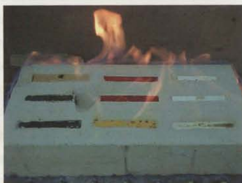
Figura 5.10 - Aspecto das amostras LOM após aplicação de vários tipos de pinturas. Da esquerda para a direita – Verniz de poliuretano, tinta acrílica amarela, tinta celulósica branca, tinta acrílica verde, tinta acrílica vermelha, tinta acrílica branca, tinta acrílica preta.
