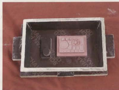
e) Caixa de moldação com modelo da bucha (305x190x60 mm).
