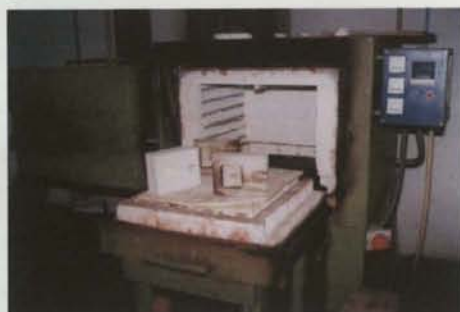
e) Moldação cerâmica e respectiva tampa após sinterização.
