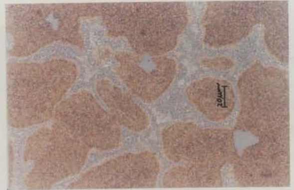
Figura 7.7 – Microestrutura de amostra obtida após vazamento em moldação cerâmica: pré aquecimento - 450 °C e temperatura de vazamento - 1010 °C. Ampliação 300x.
