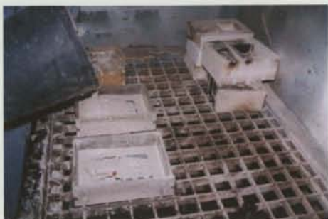
b) Vazamento da barbotina cerâmica sobre o modelo.
