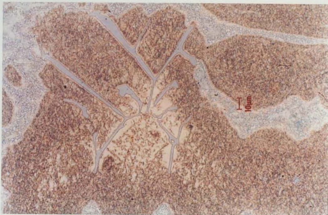
Figura 7.27 - Microestrutura da liga C 82 800 após vazamento numa moldação cerâmica. A microestrutura é constituída por fase \alpha (dendrites de cobre de cor escura), por constituinte eutectóide \alpha+\gamma (resultante da transformação eutectóide da fase \beta ) de cor clara rodeando a fase \alpha e por berilides (morfologia do tipo escrita chinesa de cor clara, ao centro). As berilides são partículas intermetálicas constituídas por Be e Ni e/ou Co. Ampliação 500x.
