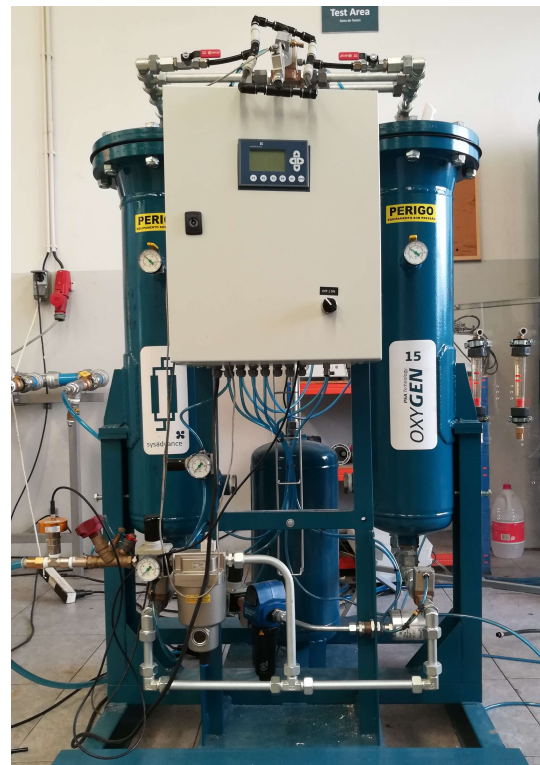
Figura 9. Configuração e fotografia da unidade PSA protótipo. Nota: a unidade industrial apresenta a mesma configuração.
