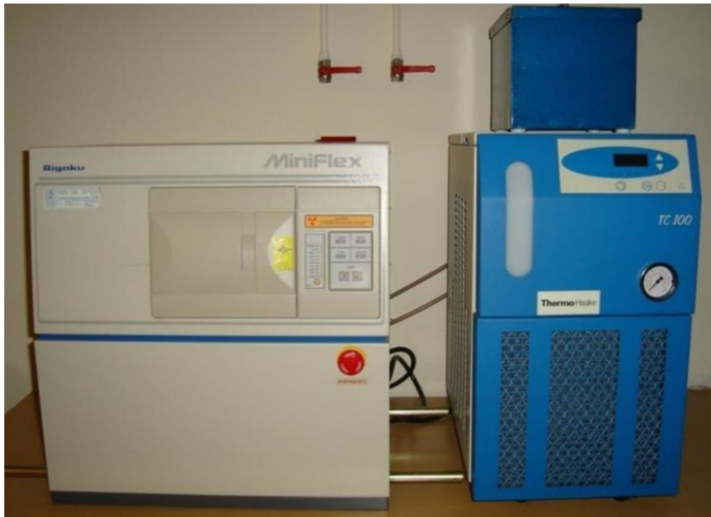
Fig. 55: Difractómetro de Raios-X, utilizado para realizar análises qualitativas e quantitativas de materiais policristalinos, modelo Miniflex da marca Rigaku.
