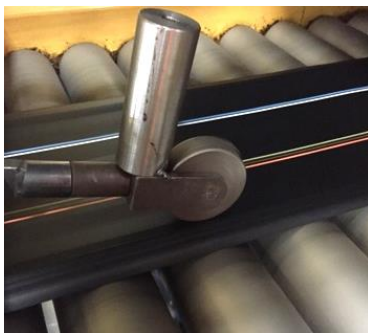
Figura 28-Instrumento de marcação de comprimento do piso.
