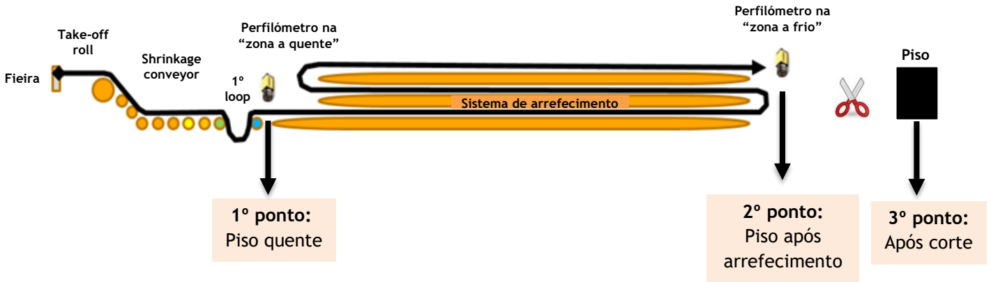
Figura B.10-Pontos de medição na linha de extrusão.
