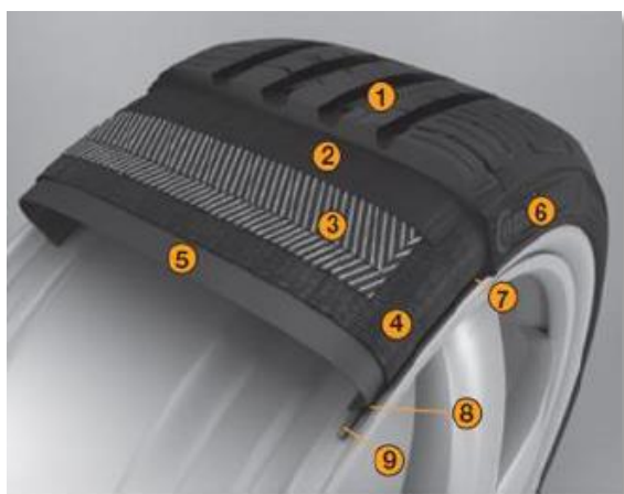
Figura 3- Secção de corte de um pneu radial e sua constituição (Continental Pneus, 2018).
