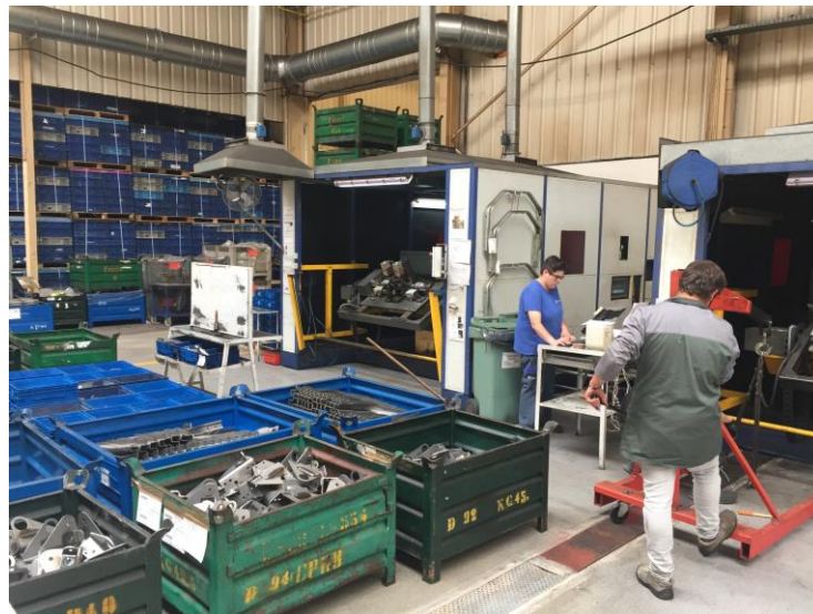
Figura 17 - Acumulação de stock no fim do processo de soldadura
