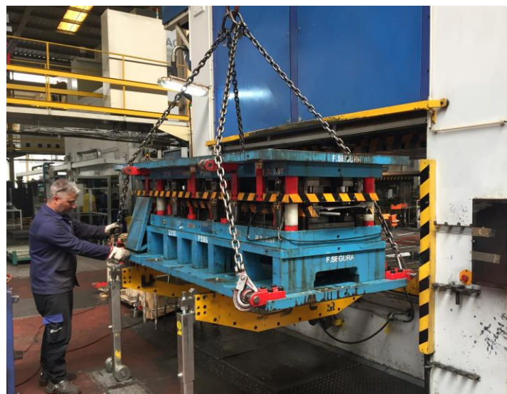
Figura 34 - Preparação de ferramenta a entrar na prensa com recurso a braços de suporte
