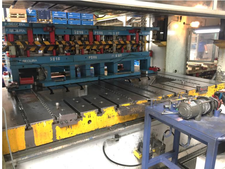
Figura 33 - Utilização de guincho elétrico para puxar e centrar a ferramenta
