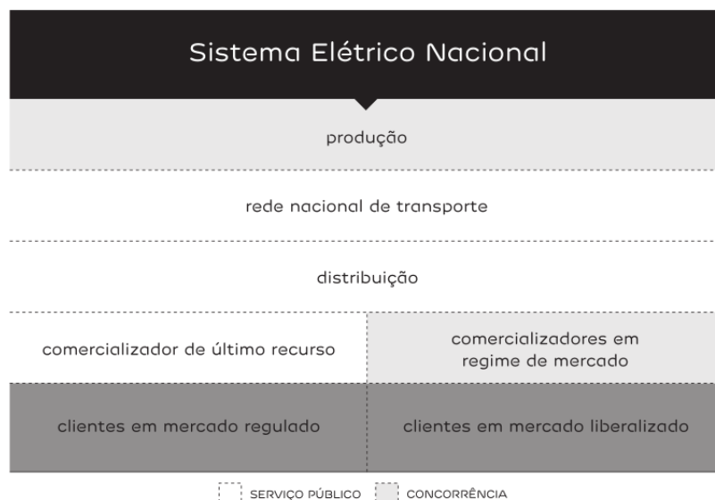
Figura 1.1 - Estruturação do Sistema Elétrico Português (SEE).
