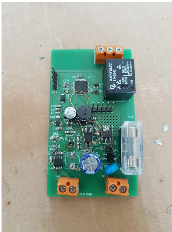
Figura 4.8: PCB1 desenvolvida com os componentes soldados
