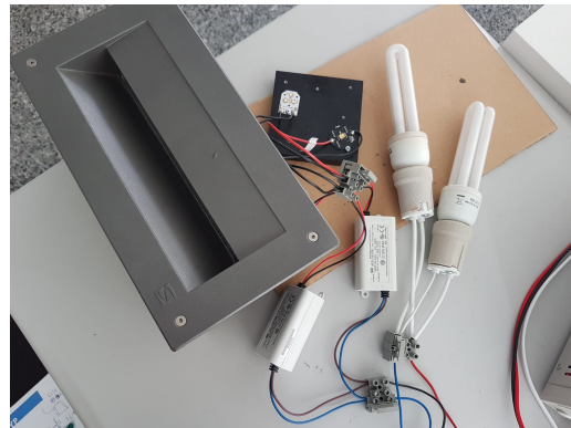
Figura 5.2: 2 lâmpadas fluorescentes e conjunto de lâmpadas LED's
