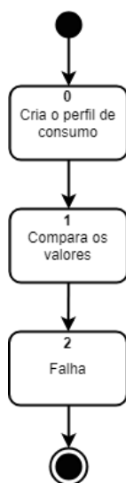
Figura 4.18: Representação da máquina de estados global do sistema
