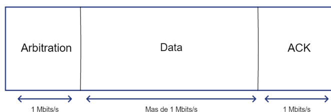
Figura 2.9: Bit-Rate em CANfd
