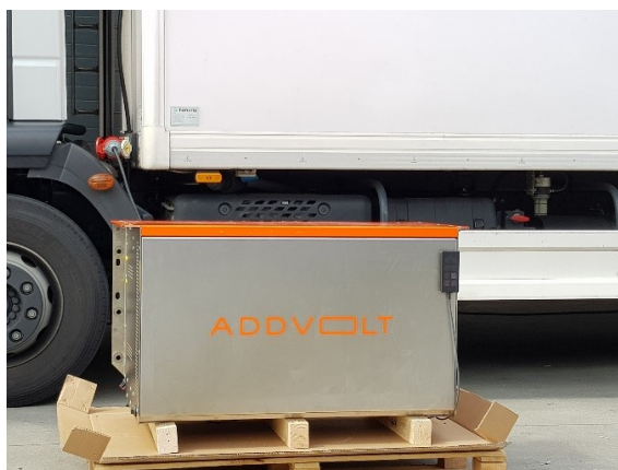
Figura 3.1: Sistema AddVolt antes de ser instalado a bordo do camião
