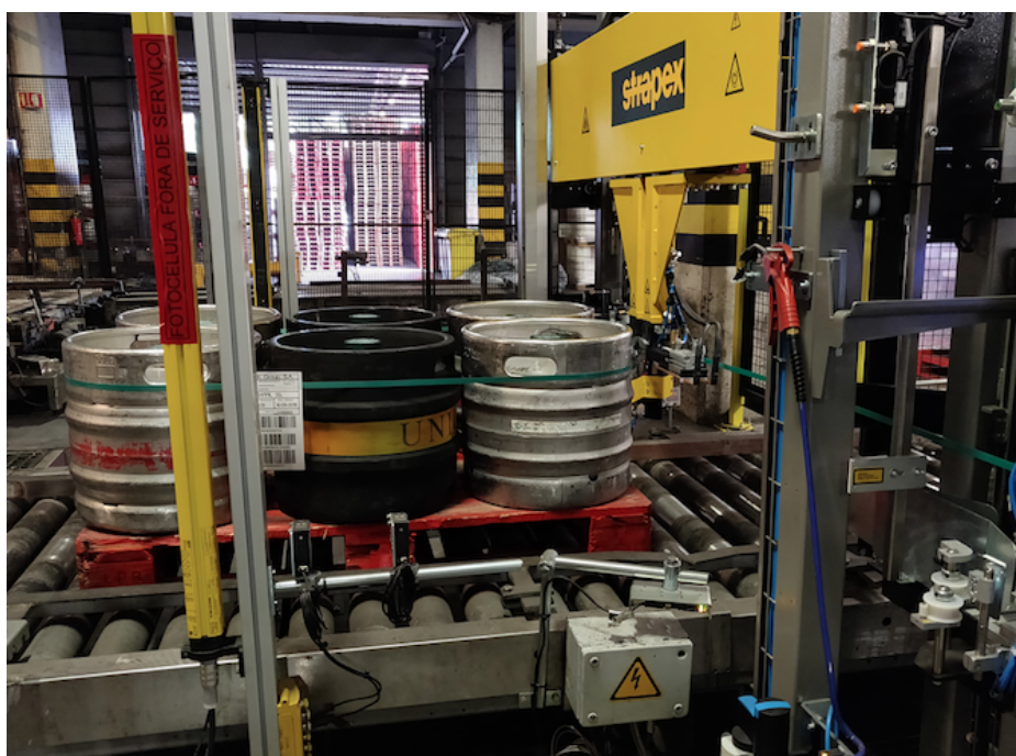
Figura 6.6: Equipamento de cintagem de paletes de barris em operação
