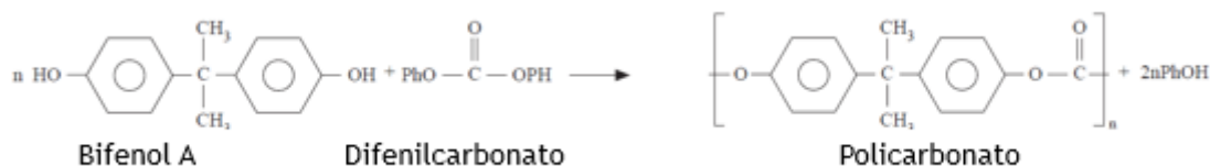
Figura 1- Reação de transesterificação na formação de um policarbonato (Adaptado de Fried, 2003).
