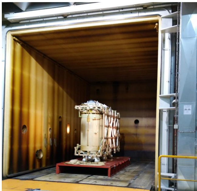
Figura 7 - Parte ativa da instalação experimental SmarTHER CORE TF na autoclave para secagem por fase de vapor (Vapour Phase).
